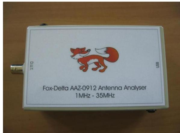
*The 1MHz – 35MHz antenna analyser*
