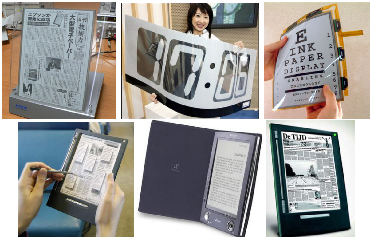
Sl. 7.12. Primeri savitljivog displeja od organskih poluprovodnika.
