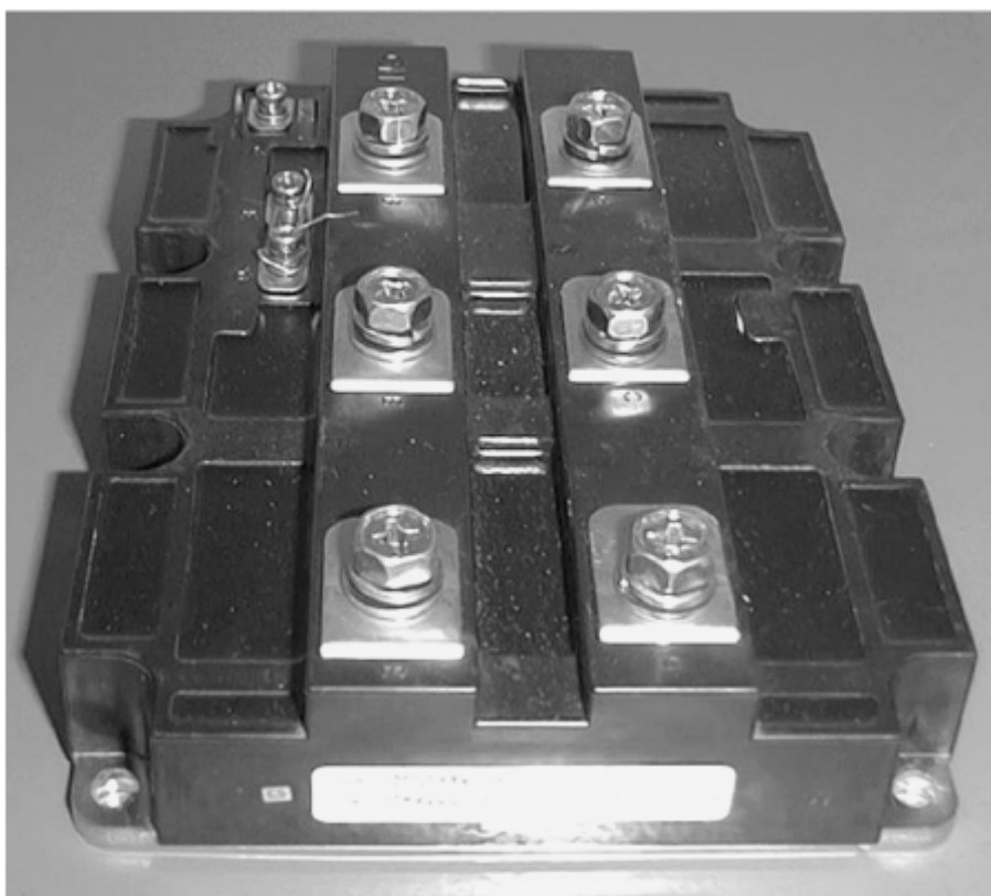
Sl. 6.32. IGBT modul proizvodnje Mitsubishi ( I_{Cmax} = 1200\text{ A} , V_{CEmax} = 3300\text{ V} ).
