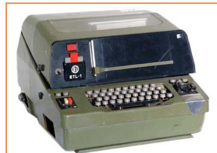
Sl. 20 Elektronski teleprinter domaće proizvodnje, fabrika "El Niš"
