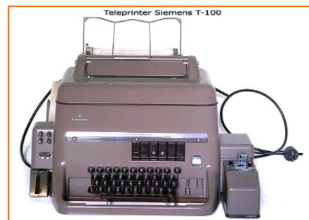
Sl. 19 Simensov električni teleprinter
