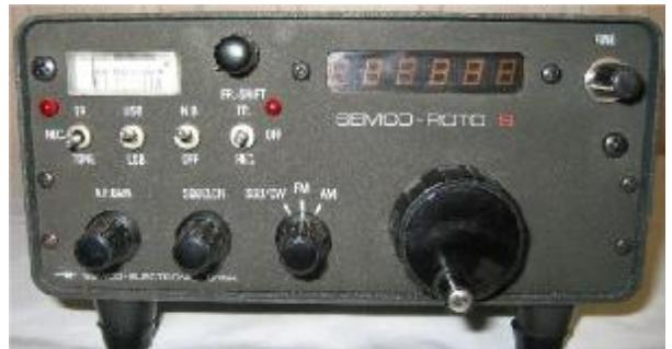
Sl.29e Fabrički VHF transiver „Semco-roto s“ sa digitalnom skalom, iz 1977.
