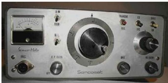
Sl.29b Fabrički VHF transiver „Semco-moto“, koji je radio u režimu rada sa „AM“ i „SSB“ („Semcoset“)
