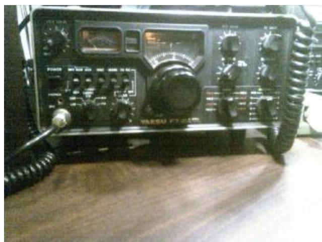
Sl. 57b Yaesu transiver za 144 MHz FT-221R koji je mogao da radi sa SSB, CW, AM i FM (1976.)
