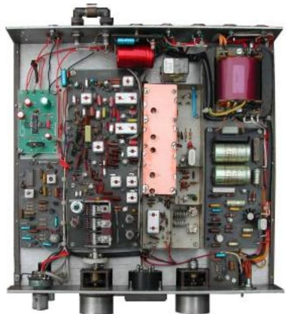
Sl.15a Čuveni konvertor firme „Semcoset“ iz Zapadne Nemačke, koji je signale iz 2m banda transponovao u 10m band (28 MHz)
