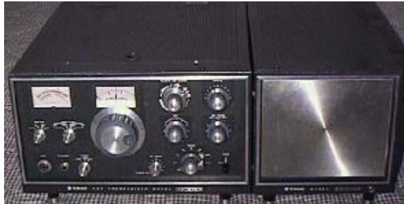
Sl. 32b Amaterski transiver „TRIO“, TS-510 sa ispravljačem i zvučnikom
