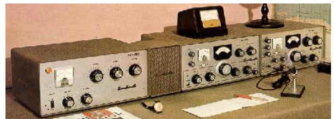
Sl.6a Nova YAESU "F" linija HF SSB uređaja za radioamatere. S' leva na desno su: linearni pojačavač FL-1000, koji daje 1,5KW na amaterskim KT bandovima; zvučnik SP-100; prijemnik FR-100B i predajnik FL-100B, snage 100W
