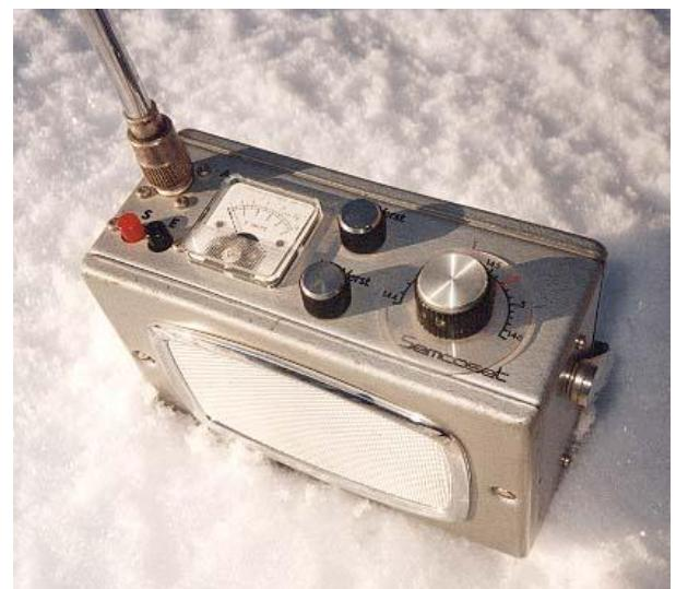
Sl.29a Pogled odozgo na VHF trasiver (AM) „Semco“; izlazna snaga mu je bila oko 500 mW
