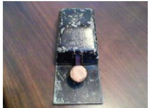
SL.40 Nemački ručni taster iz II Svetskog rata marke „D.R.P. Junker“ (ja sam mu na ručki stavio vosak zbog lakšeg kucanja na QRQ takmičenjima)
