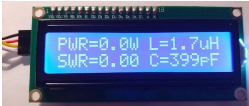
Fig.3. Afișaj LCD alfanumeric 2linii x 16caractere
