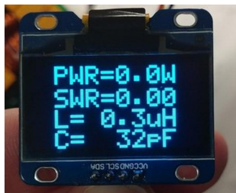
Fig. 4. Afișaje OLED care pot echipa ATU-100. Stânga: 128x32. Dreapta: 128x64.
