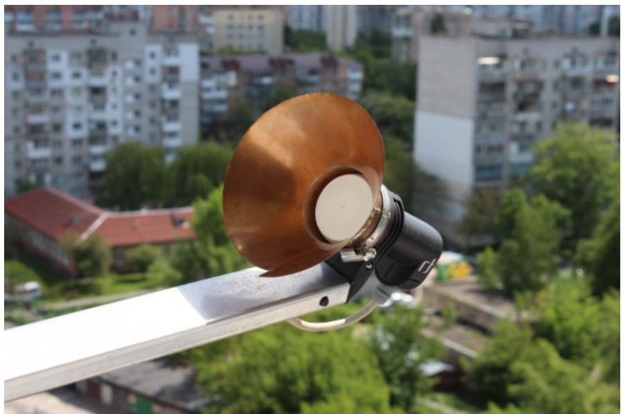
Как видно из сопоставления спектров и сводной таблицы транспондеров, установка бленды привела к увеличению SNR до 1.3 - 3.1 dB !!! на отдельных каналах (смотри красные цифры в левой таблице):
