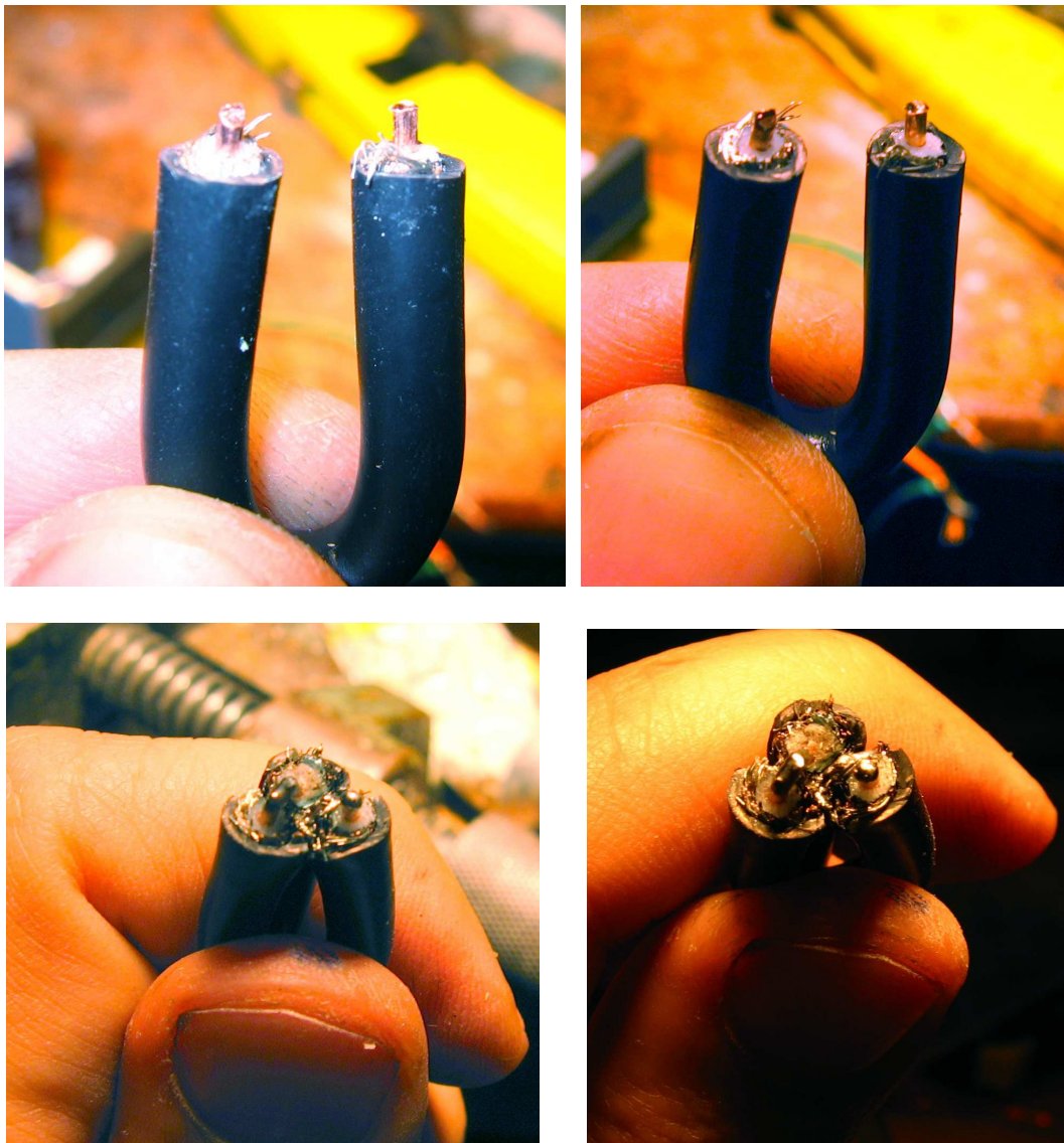
Priprema i lemljenje petlje i kabla
