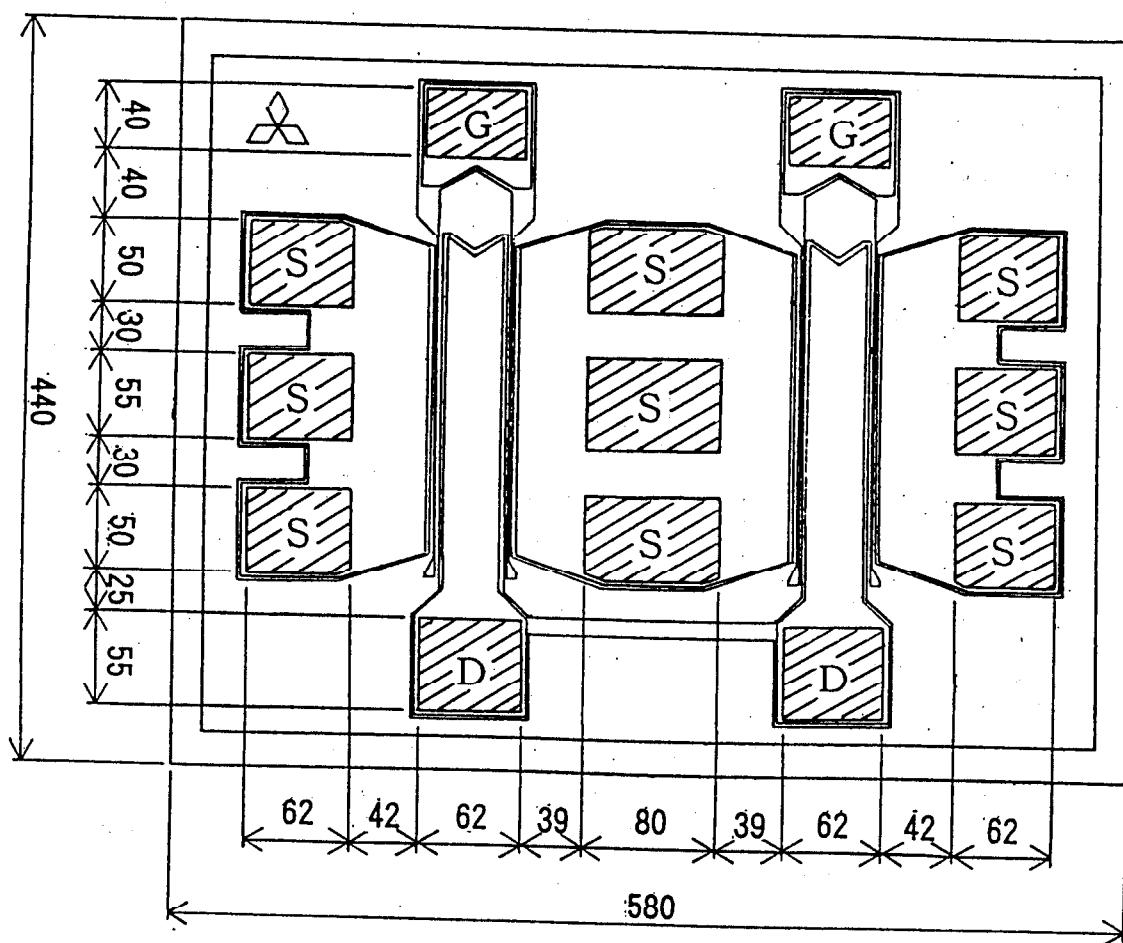
Chip Thickness :  $145 \pm 20 \mu\text{m}$
