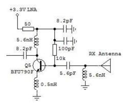
Fig. 10 - LNA schematic
