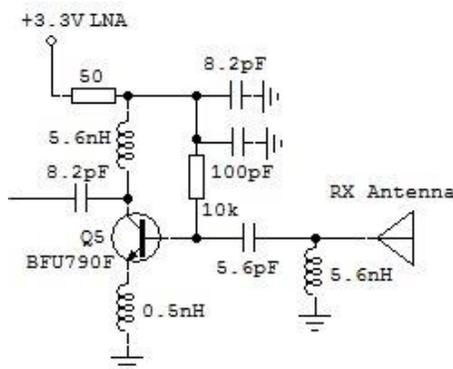
Fig. 10 - LNA schematic
