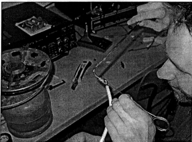
Malo večji plinski spajkalnik z prenosno špico.
