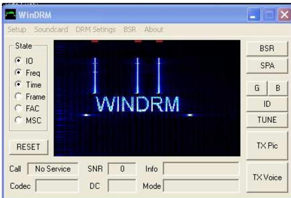
Clique com o botão esquerdo do mouse em TUNE e será transmitido um arquivo de áudio pré-gravado para ajustar e definir o nível de saída adequada do transmissor, composto de três sinais piloto de referência (sincronismo).
