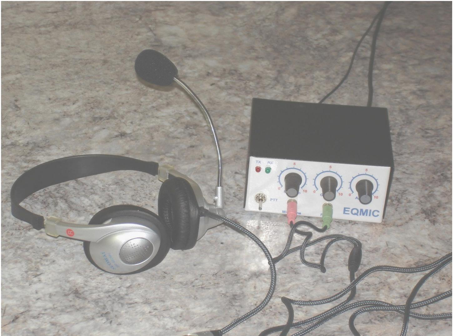
**Atenção= Antes de iniciar a montagem, lembre-se de usar ferro de solda de 30W para soldagem dos componentes. Use solda de boa qualidade, liga tipo 60/40. Siga as instruções passo a passo, isso irá diminuir a chance de ter problemas de funcionamento.**
