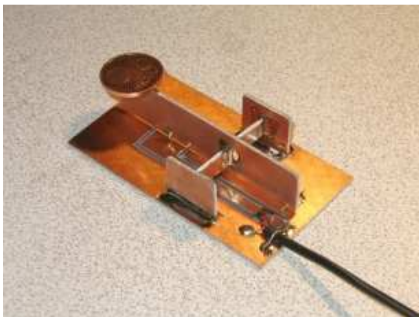
“Pica-Pau” ou “Cabeçote” caseiro ( feito com placas de circuito impresso de dupla face )
