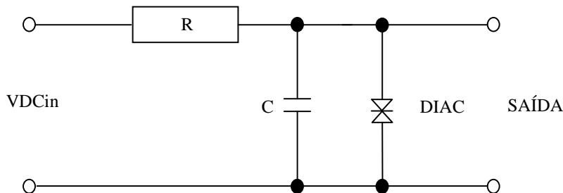
A tensão de entrada tem de ser DC, mas pode ser de qualquer polaridade, apenas respeitando-se a polaridade do capacitor, se existir.
