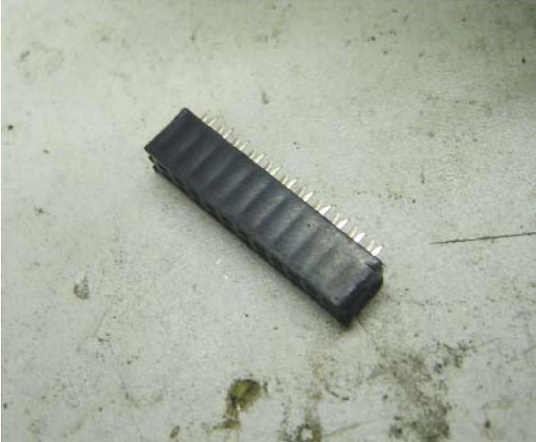
Desmonte um cabo velho de disquete e tire o conector, corte de forma que sobrem apenas 11 terminais no seu comprimento. Retire os pinos de uma das fileiras, deixando apenas uma conforme abaixo.
