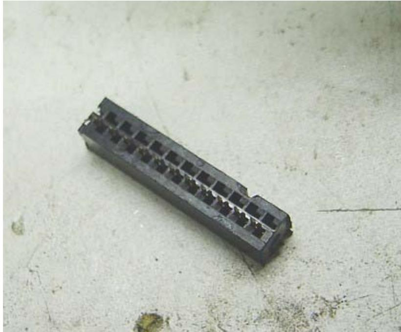
Solde um pedaço de fio fino no pino 12 do uPD857, no caso da foto abaixo o fio amarelo. Usei um fio de cabo telefônico, desses que passam na rua, qualquer fio bem fino serve. Com um alicate de bico vá encaixando o fio no "v" do conector, conforme na foto abaixo. A combinação neste caso é 000100100001, ou seja onde estiver marcado "1" vai ligado o fio que leva 5V "roubado" do pino 12 do PLL e zero não vai ligado nada, fica em aberto. (lógica binária 0 = 0V e 1 = 5V)
