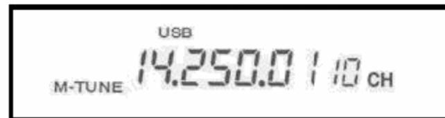
Display do modo M-TUNE exibindo a memória 10 resintonizada (+10 Hz). Pressione **VFO/M** uma vez para cancelar as mudanças e voltar ao modo MEM, e pressione-a novamente para voltar ao modo VFO.
