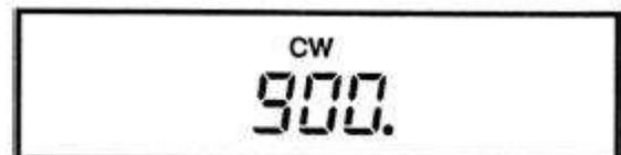
Você pode usar o **DIAL** ou as teclas —**BAND**— **UP** / **DOWN** para selecionar o offset desejado. Pressione **CW/N** novamente para salvar o ajuste e voltar ao display normal.
