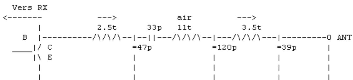
As bobinas com uma seta em cima são as originais com núcleo do TX. A bobina com núcleo de ar tem 11 espiras com diâmetro de 6mm. (Pode ser melhorado, mas funciona de primeira assim).
