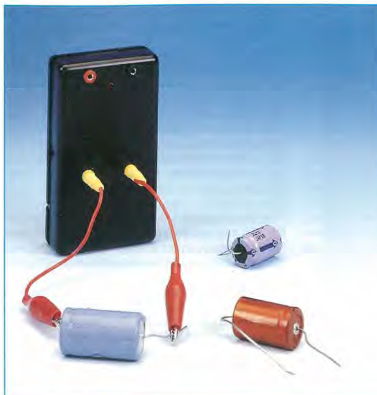
Fig.9 Più i condensatori elettrolitici sono vicini all'esaurimento, minore sarà il valore in microamper della corrente che leggerete sul Tester (vedi fig.11). Se un condensatore elettrolitico è in cortocircuito vedrete subito accendersi il diodo led DL1.
