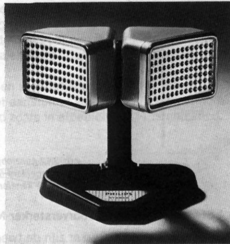
Afb. 3.8 De stereomicrofoon N 8402 bestaat uit twee elektrodynamische microfoons, die een hoek van 90^\circ met elkaar maken. De microfoons kunnen van de standaard worden genomen en op een onderlinge afstand van maximaal 2,1 m worden geplaatst. Het frequentiebereik is 120 Hz tot 16 kHz. De impedantie bedraagt 400 \Omega .
