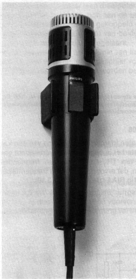
Afb. 3.8 De stereomicrofoon N 8402 bestaat uit twee elektrodynamische microfoons, die een hoek van 90^\circ met elkaar maken. De microfoons kunnen van de standaard worden genomen en op een onderlinge afstand van maximaal 2,1 m worden geplaatst. Het frequentiebereik is 120 Hz tot 16 kHz. De impedantie bedraagt 400 \Omega .
