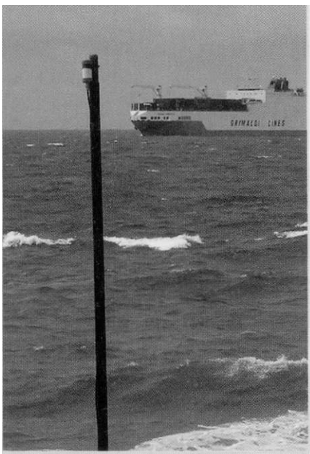
Foto 8 Westkapelle, mini-Whip op kunststof mastdeel
