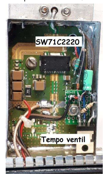
Le PA platine UMTS modifiée
