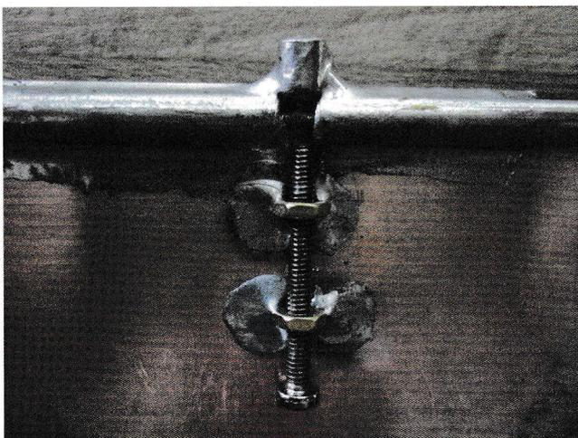
**Bild 3:** Fertig aufgebautes Notchfilter aus Semirigid-Koaxialkabel UT-141
