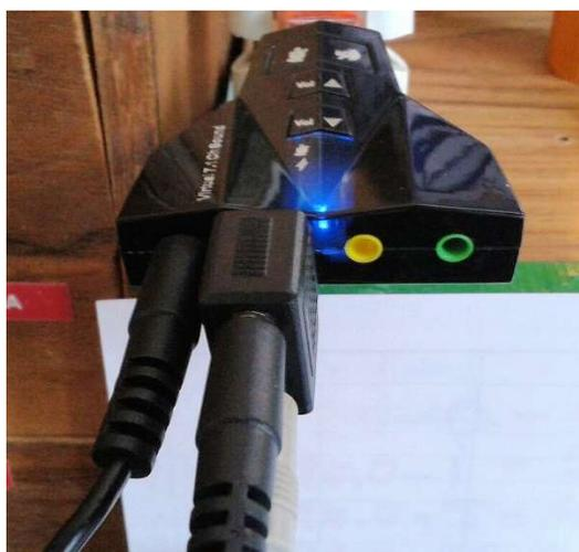
Cette solution matérielle, utilisée par mon ami Serge **ON3WP**, consiste à insérer une carte son USB dans le PC, et d'y raccorder les entrées HP et micro (attention au niveau !). Dans le setup de MMSSTV, il faut choisir cette carte son pour l'entrée (In) et la sortie (Out).
