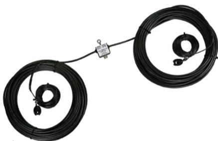
3. Antennes « bazooka » : il s'agit d'antennes mono-bandes fabriquées à partir d'un câble coaxial 75 ohms léger. Elles ont une bande passante particulièrement large, ce qui évite d'avoir recours à un coupleur d'antenne et permet ainsi d'atteindre des performances très intéressantes.
