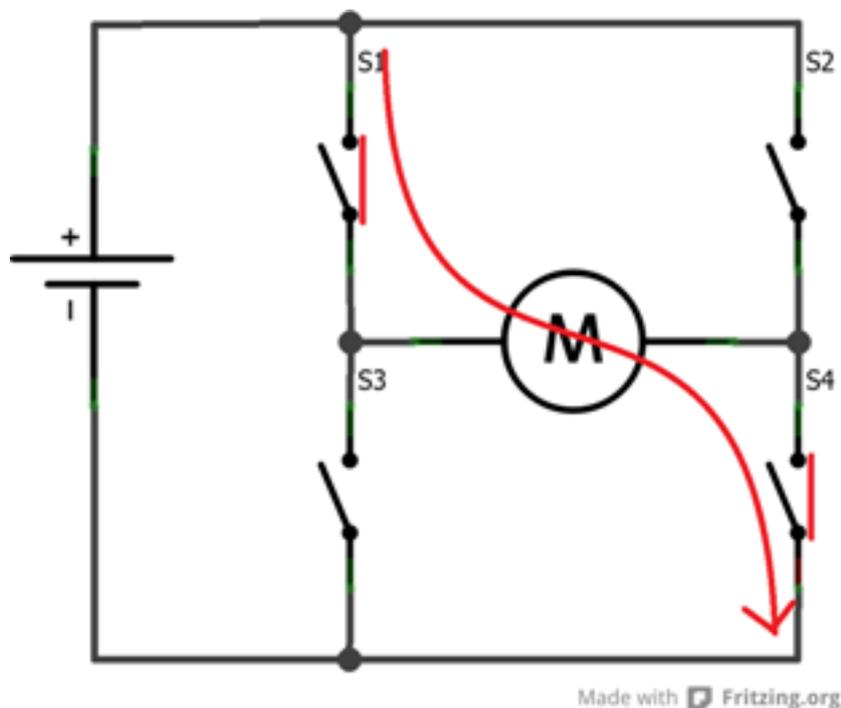
FIGURE VI.1.36. – Fonctionnement dans le sens horaire
