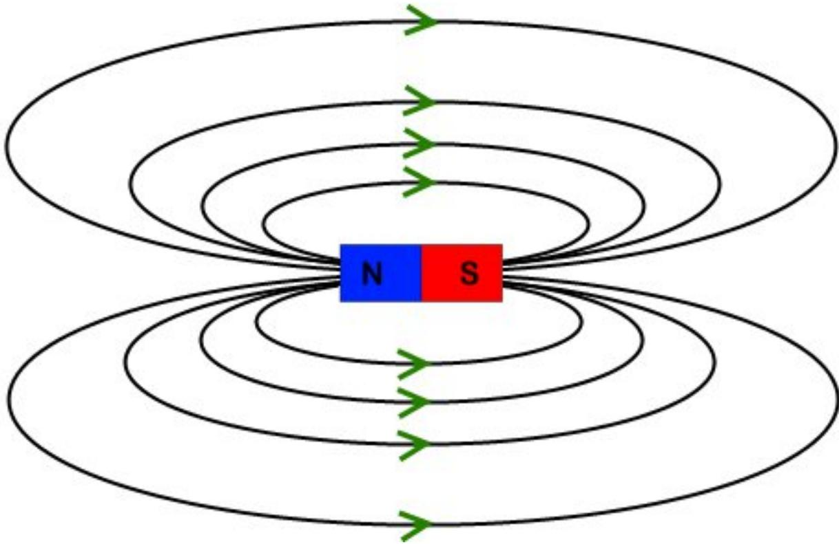
FIGURE VI.1.5. – Champ magnétique généré par un aimant permanent
