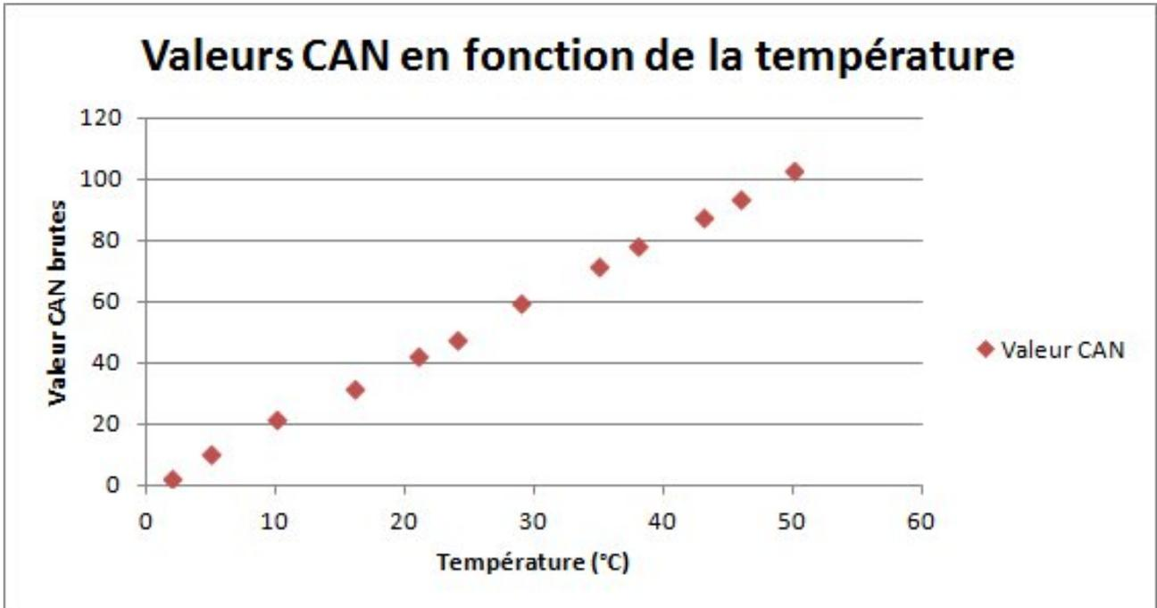
FIGURE V.2.23. – Valeurs CAN en fonction de la température
