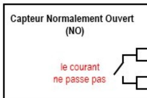
FIGURE V.2.1. – Schéma d'un capteur normalement ouvert
