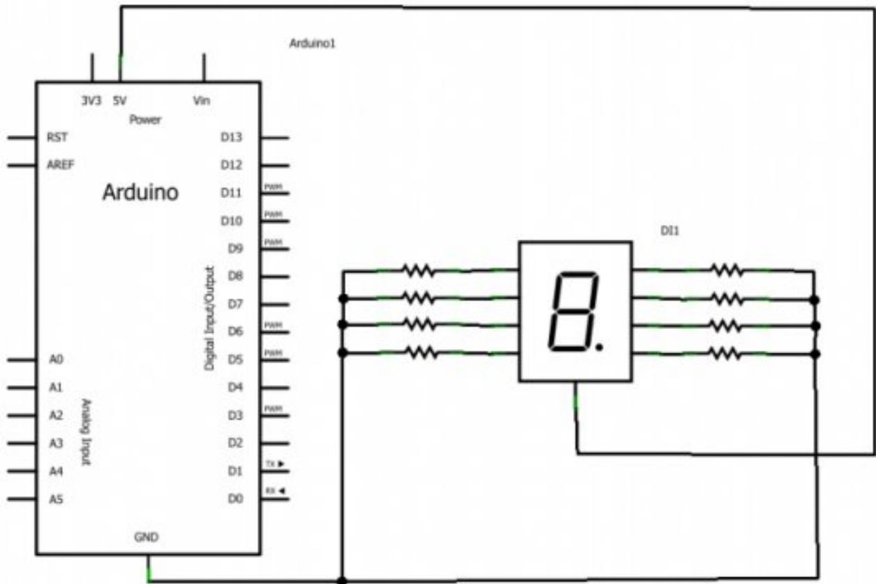
FIGURE II.5.7. – 7 segments schéma
