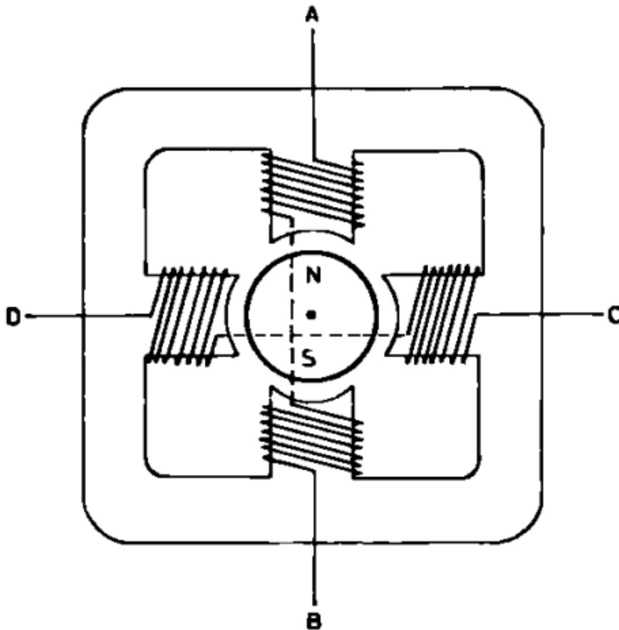
FIGURE VI.3.15. – Vue schématisé d'un moteur pas-à-pas
