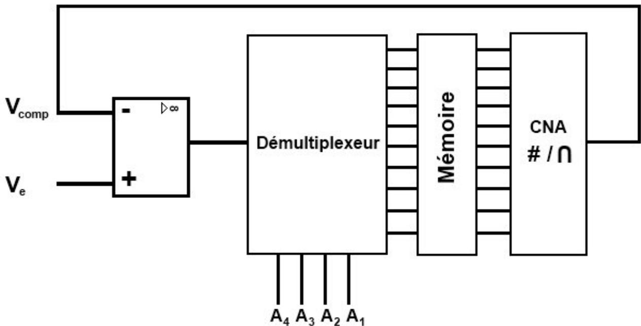
FIGURE IV.1.8. – Chaîne de fonctionnement du CAN
