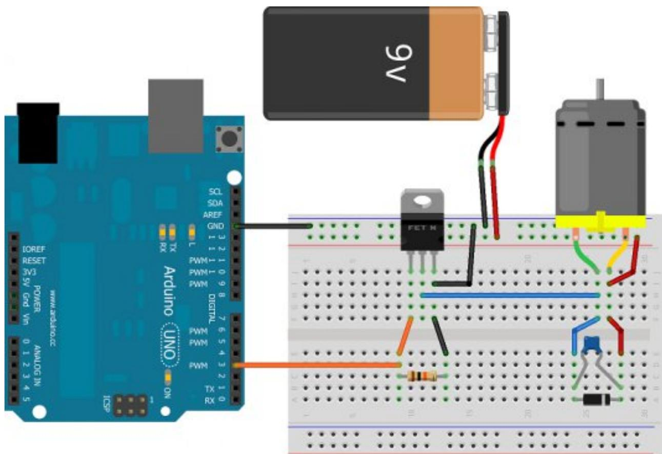
FIGURE VI.1.32. – Montage complet du moteur CC
