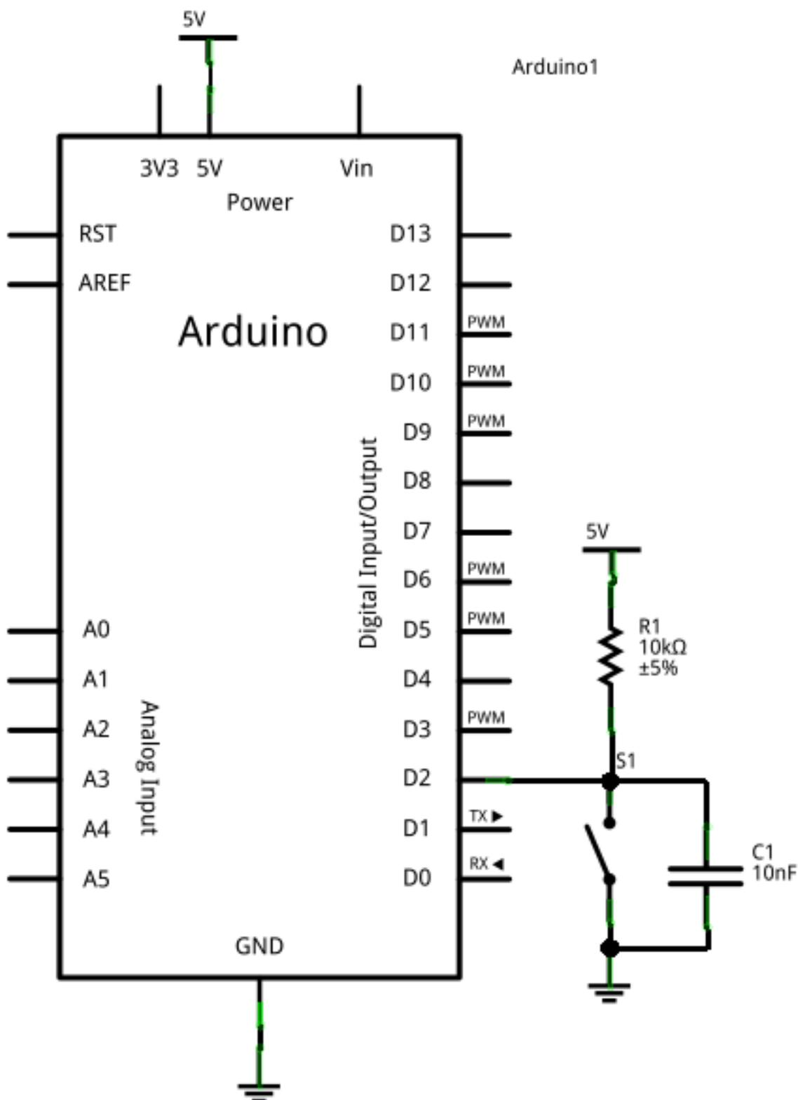
FIGURE II.4.5. – Un bouton + résistance pullup - Schéma
