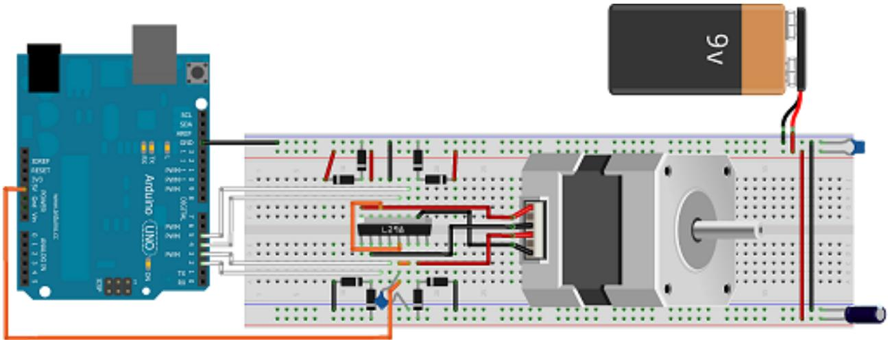
FIGURE VI.3.25. – Câblage du moteur bipolaire - Montage
