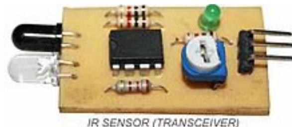
FIGURE V.1.4. – Détecteur infrarouge - (CC-BY-SA, [robotplatform.com](https://robotplatform.com) [↗](#))
