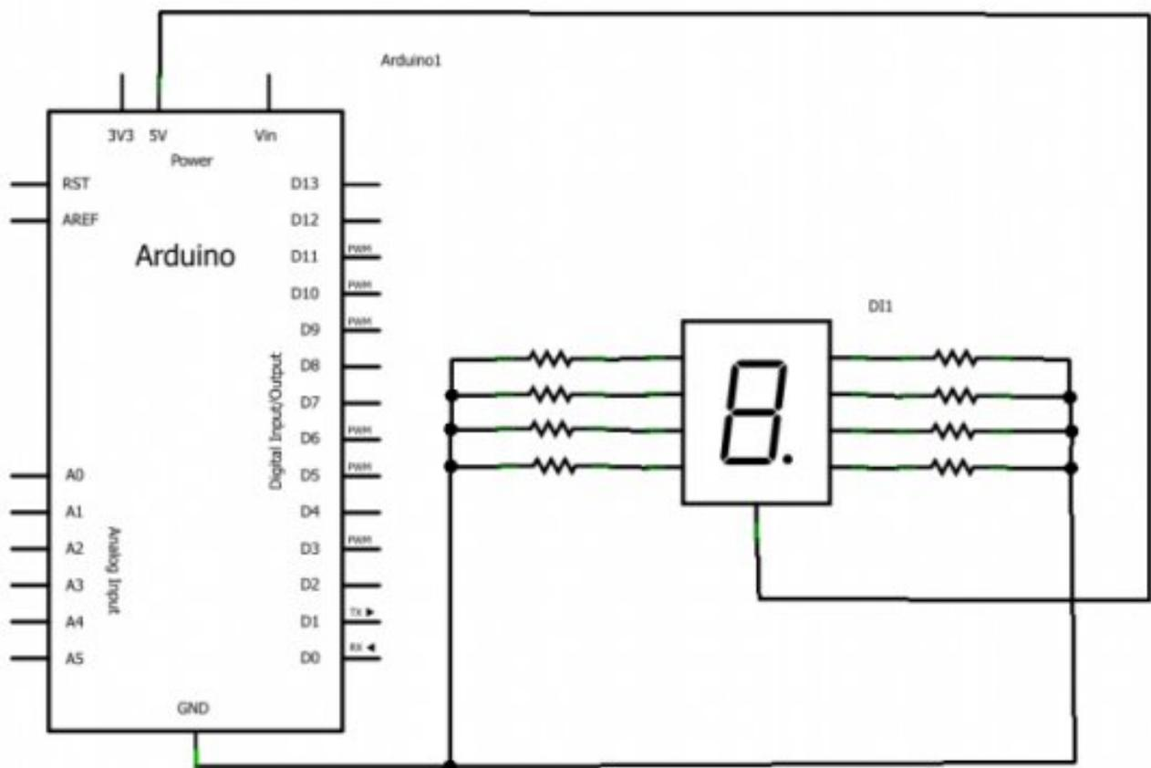
FIGURE II.5.5. – 7 segments schéma
