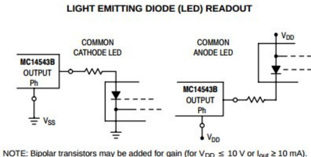
FIGURE II.5.9. – Branchement du MC14543B - (source : datasheet)
