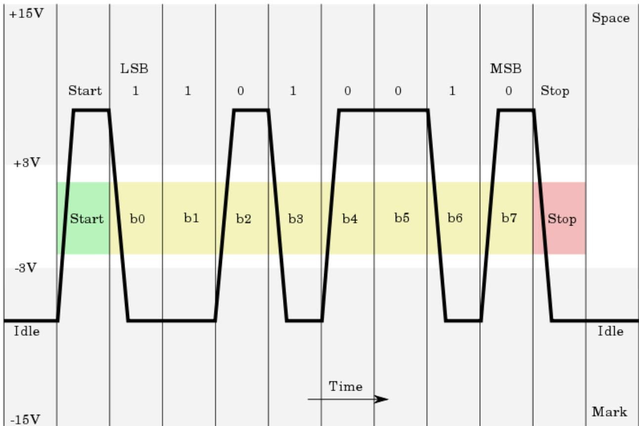
FIGURE III.1.5. – Protocole de la norme RS-232 - (CC-SA, [Ktnbn ↗](#))
