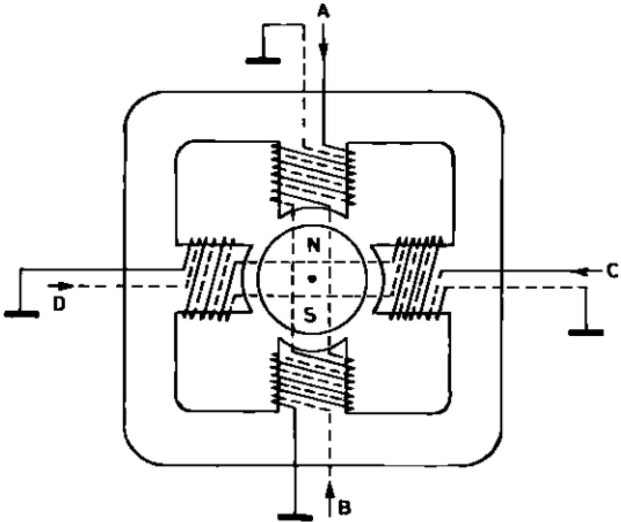
FIGURE VI.3.5. – Vue en coupe d'un moteur pas-à-pas unipolaire
