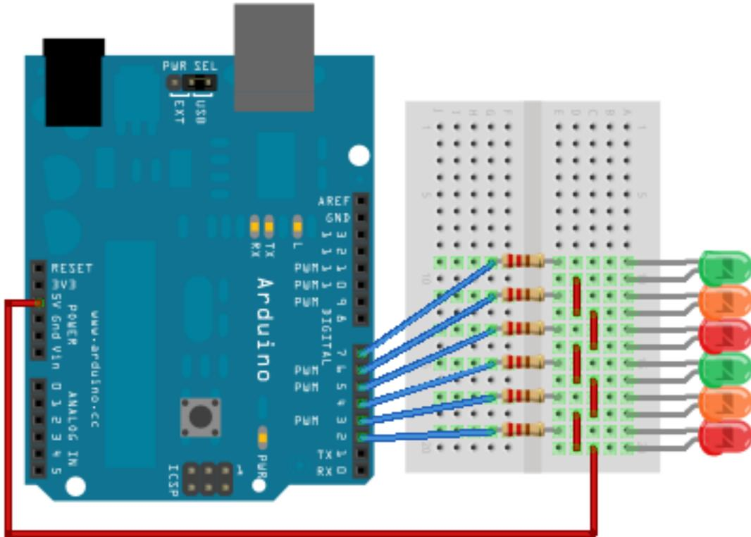
FIGURE II.3.2. – Montage TP feux de signalisation
