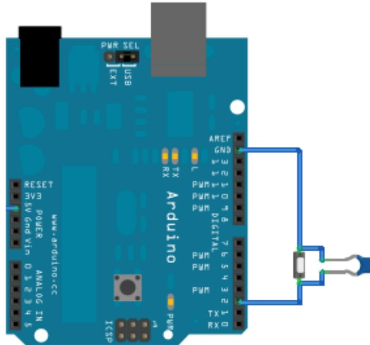
FIGURE II.4.8. – Un bouton + résistance pullup interne - Montage
