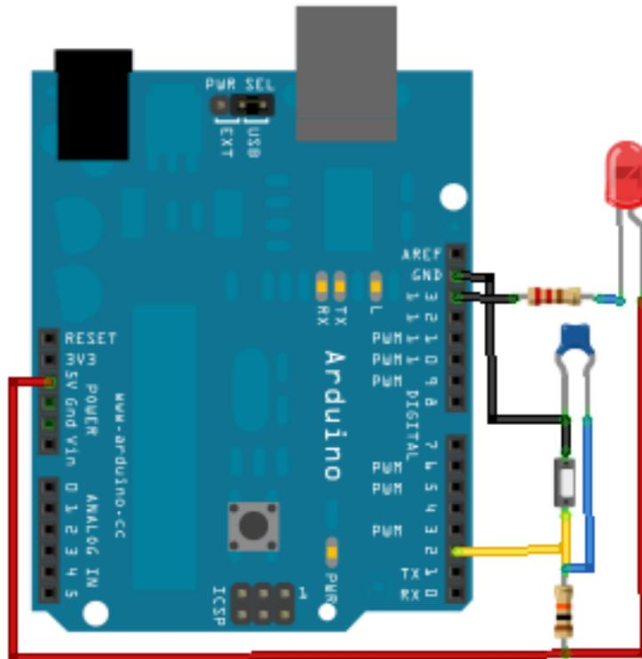
FIGURE II.4.10. – Un bouton et une LED - Montage
