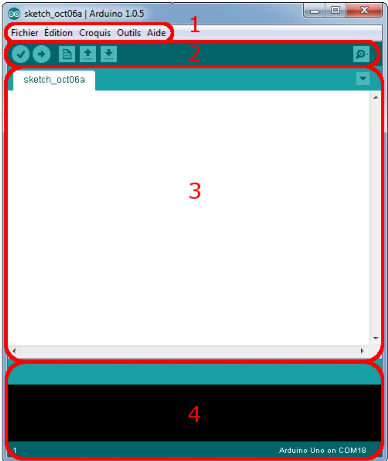
FIGURE I.3.6. – L'interface de l'IDE Arduino en détail
