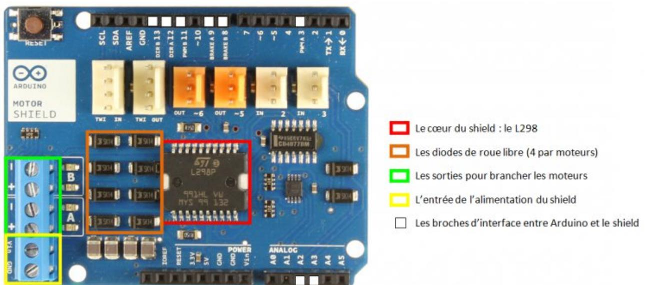
FIGURE VI.1.49. – Le shield moteur officiel en image
