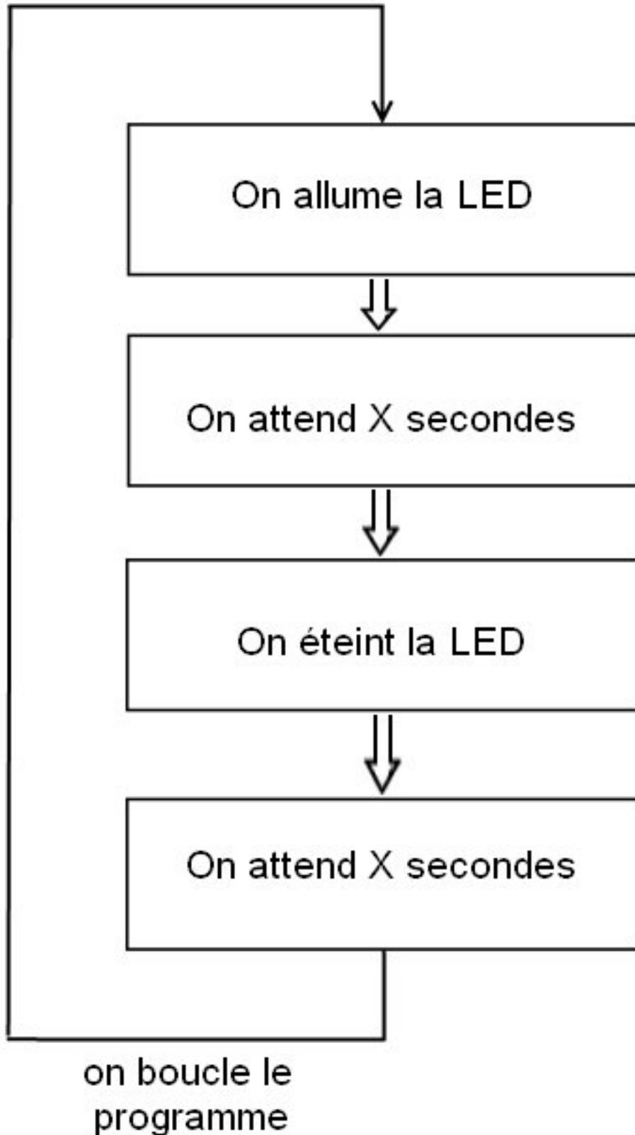
FIGURE II.2.1. – Schéma de principe du clignotement
