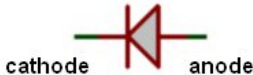
FIGURE VI.1.29. – Symbole d'une diode
