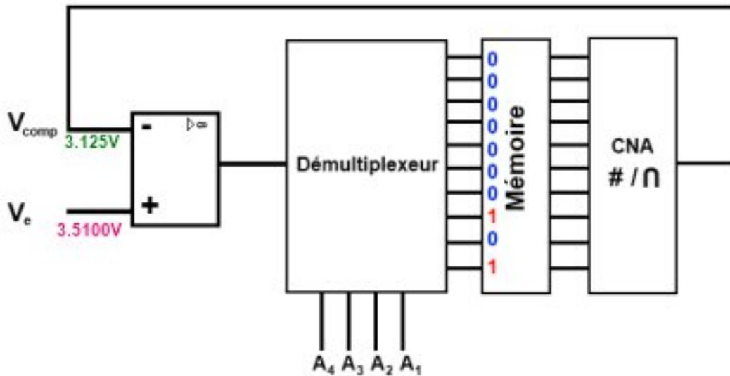
FIGURE IV.1.12. – Chaîne de fonctionnement du CAN - Exemple - Etape 3
