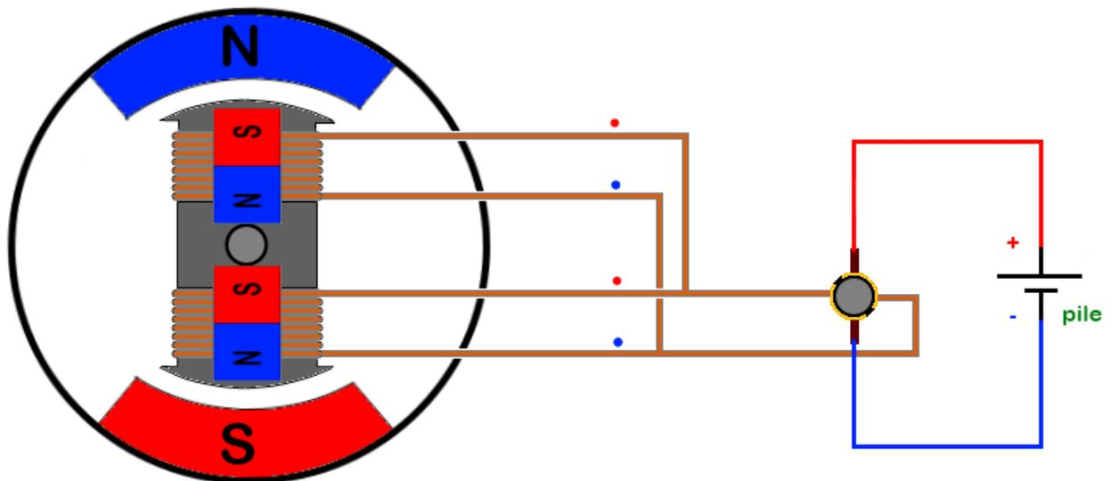
FIGURE VI.1.13. – L'axe du moteur se met à tourner
