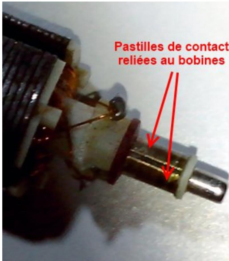
FIGURE VI.1.15. – Rotor d'un moteur à courant continu, encore
