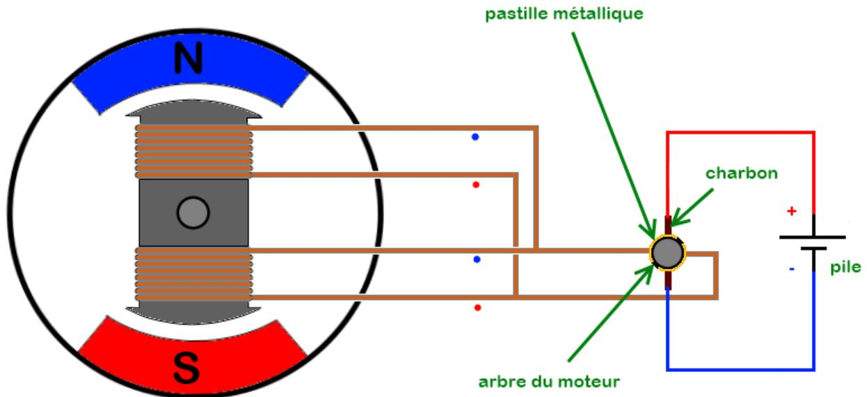
FIGURE VI.1.11. – Schéma complet du moteur
