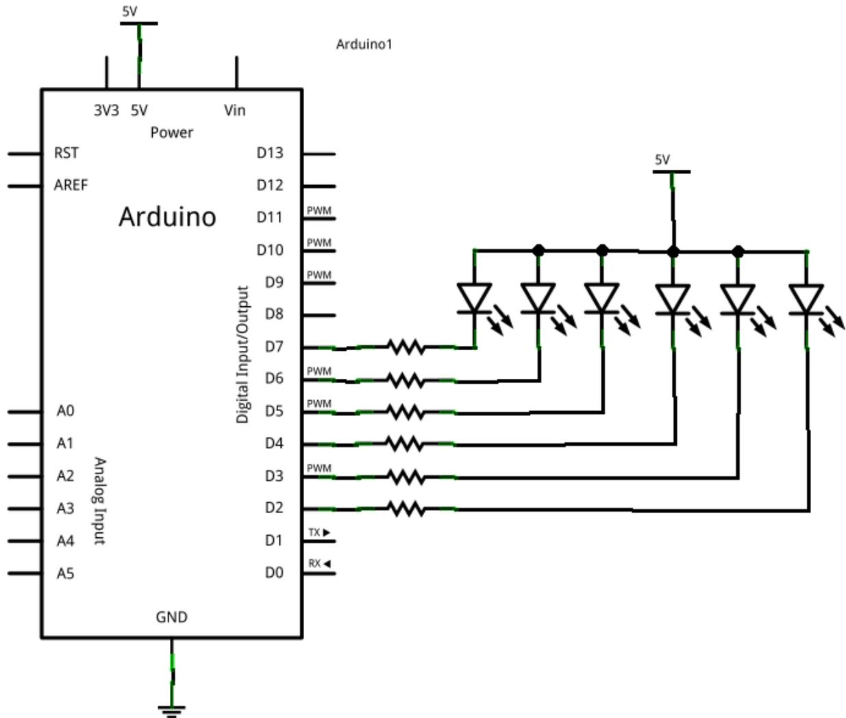
FIGURE II.3.1. – Schéma TP feux de signalisation
