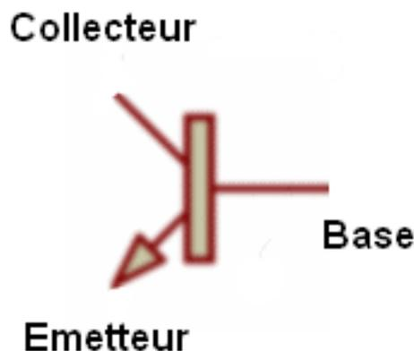
FIGURE II.5.12. – Symbole du transistor bipolaire
