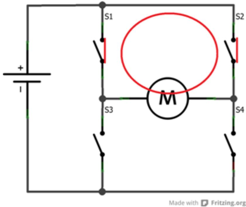
FIGURE VI.1.38. – Freinage avec 1 & 2
