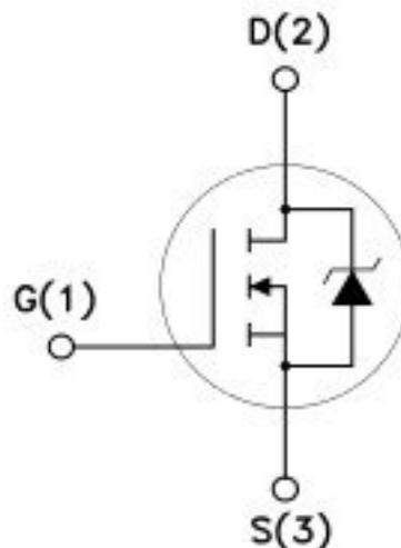
FIGURE VI.1.27. – Symbole du transistor MOSFET (canal N)
