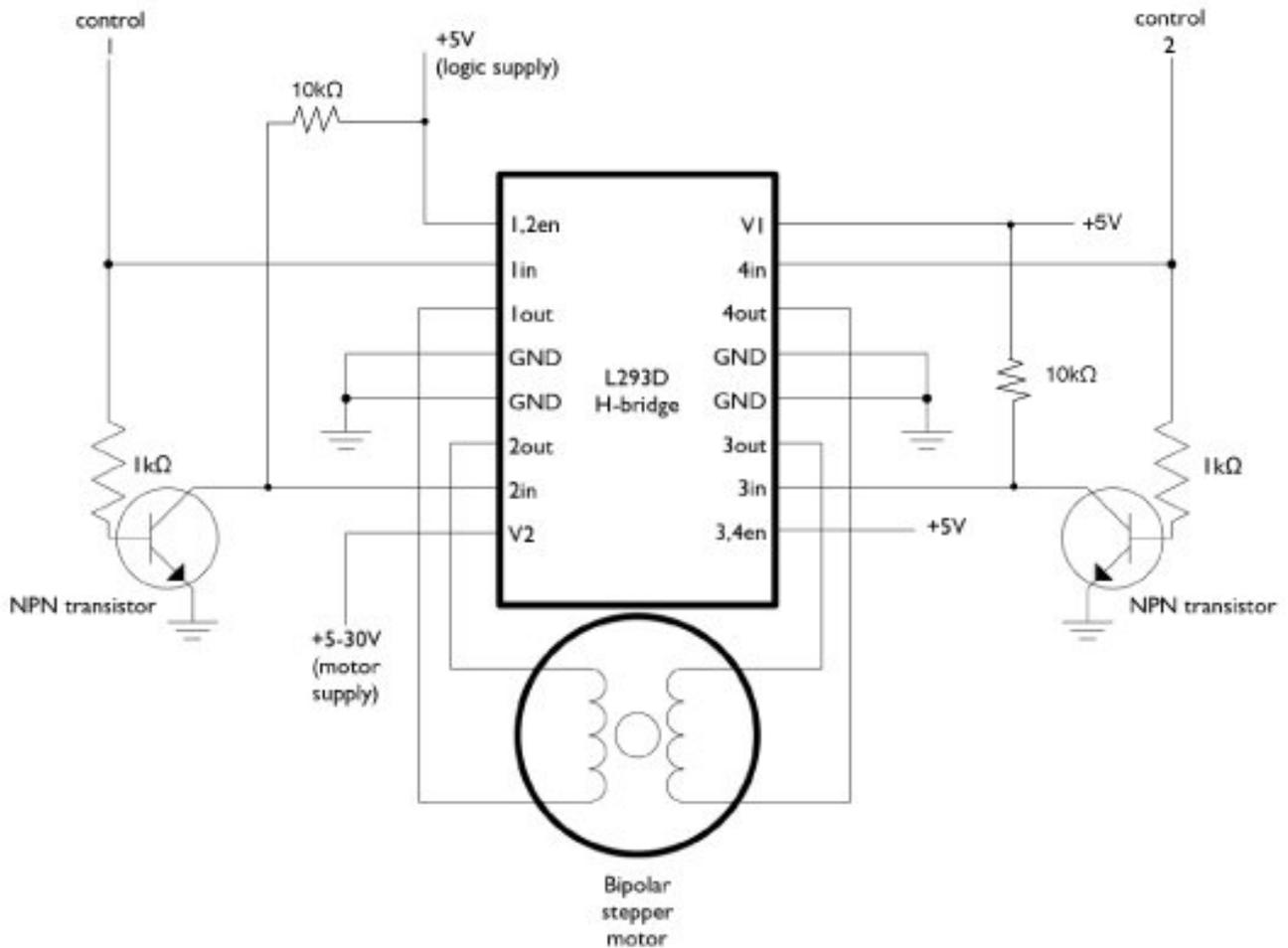
FIGURE VI.3.26. – Moteur bipolaire avec 2 fils
