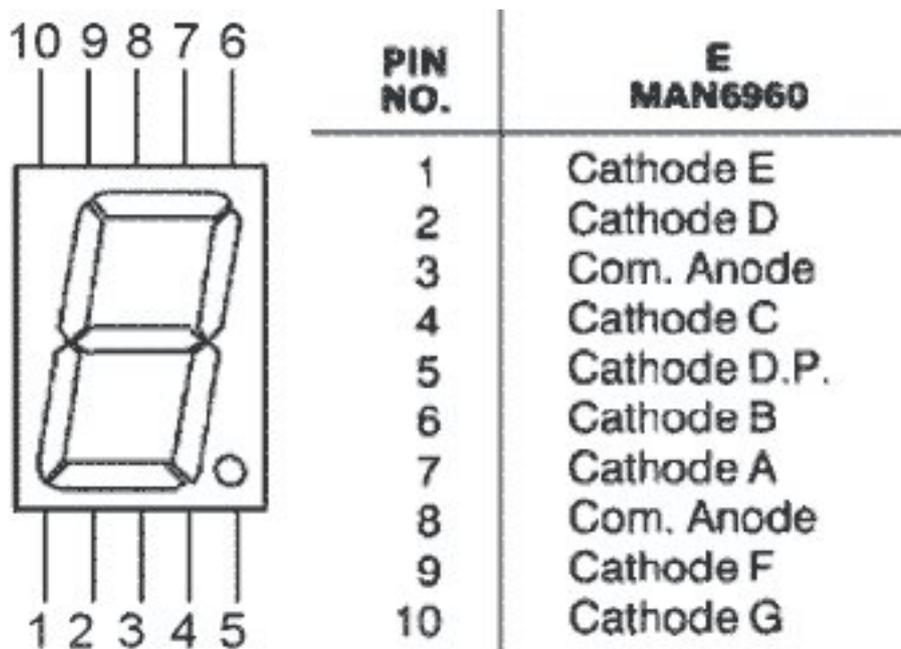
FIGURE II.5.3. – Boîtier du 7 segments - (source : datasheet)
