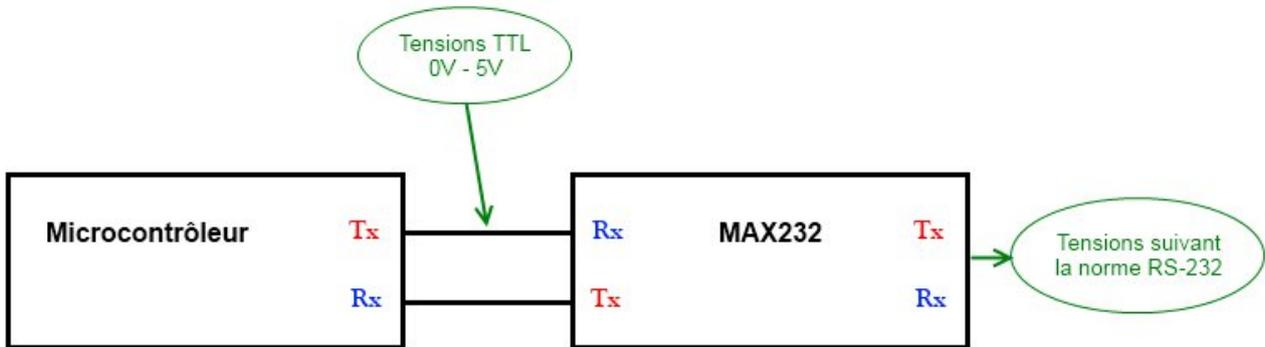
FIGURE III.1.14. – Lien entre microcontrôleur et MAX232
