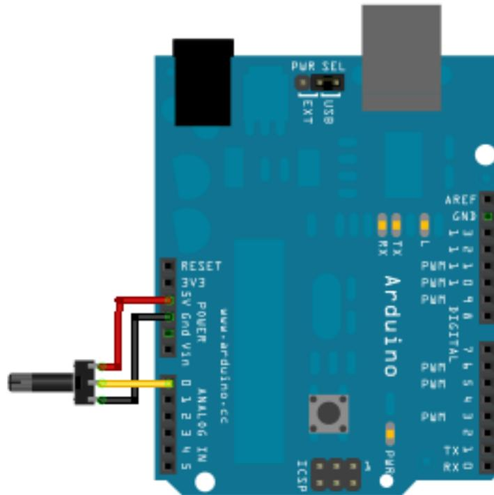
FIGURE IV.1.16. – Potentiomètre - Montage
