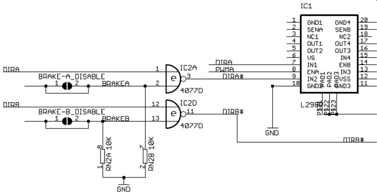
FIGURE VI.1.50. – Astuce de pilotage du moteur
