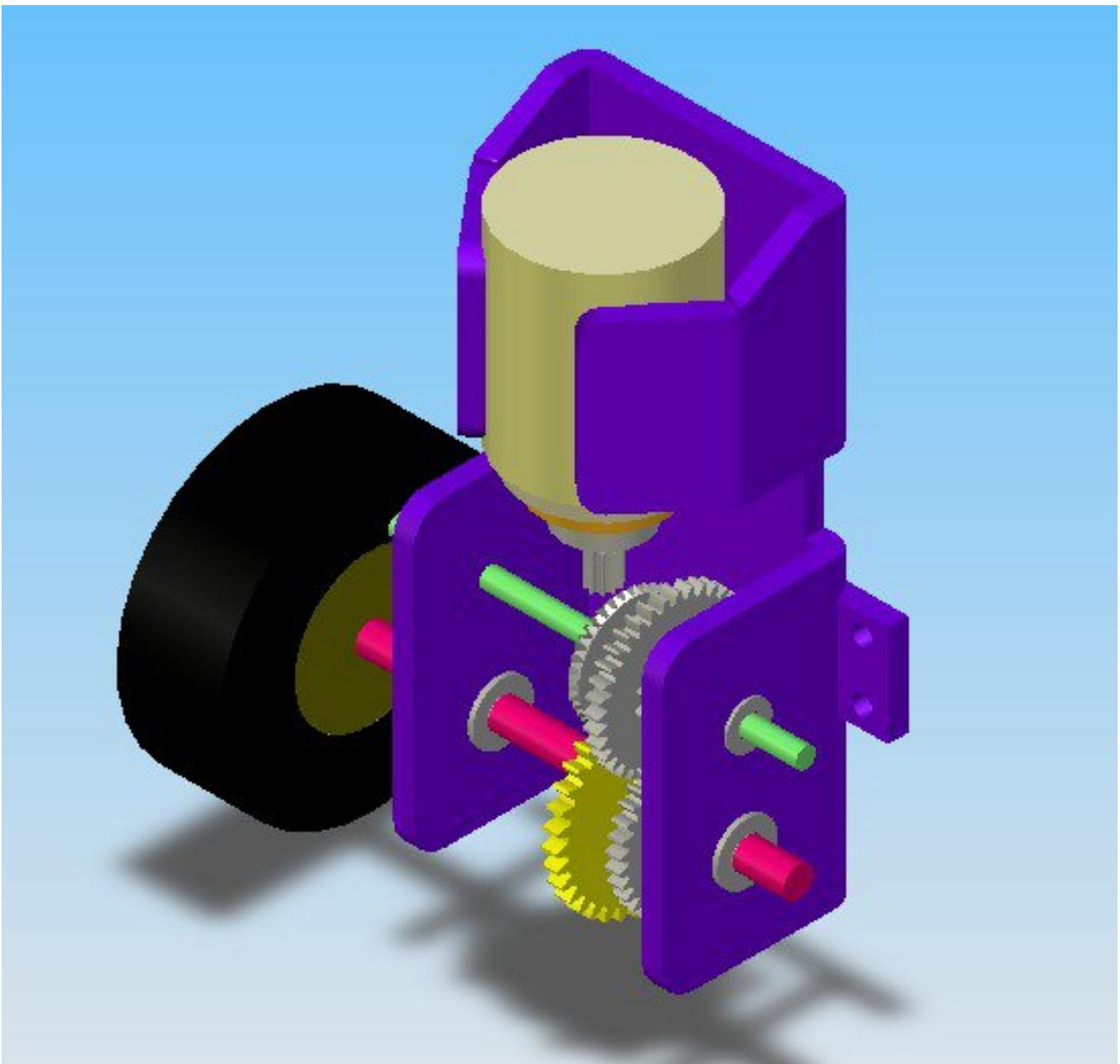
FIGURE VI.1.20. – Ensemble moteur + réducteur + roue
