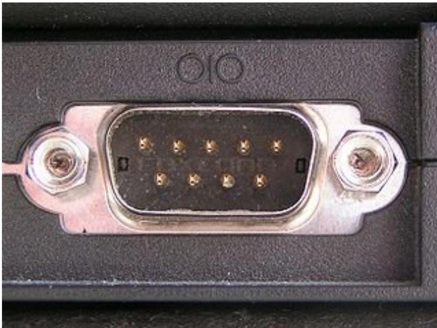
FIGURE III.1.10. – Connecteur DB9 Mâle
