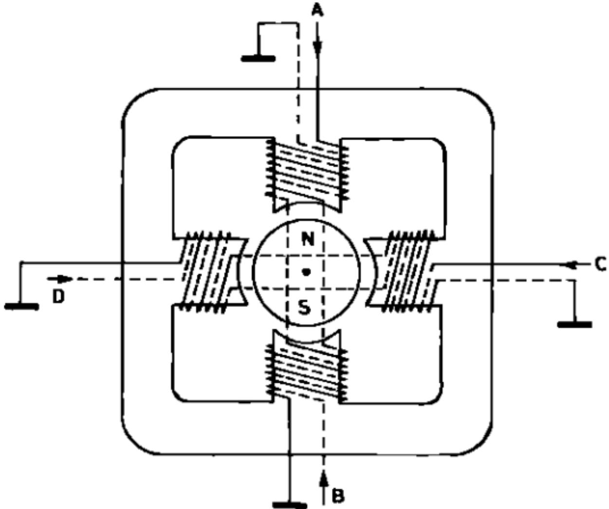
FIGURE VI.3.7. – Vue en coupe d'un moteur pas-à-pas unipolaire
