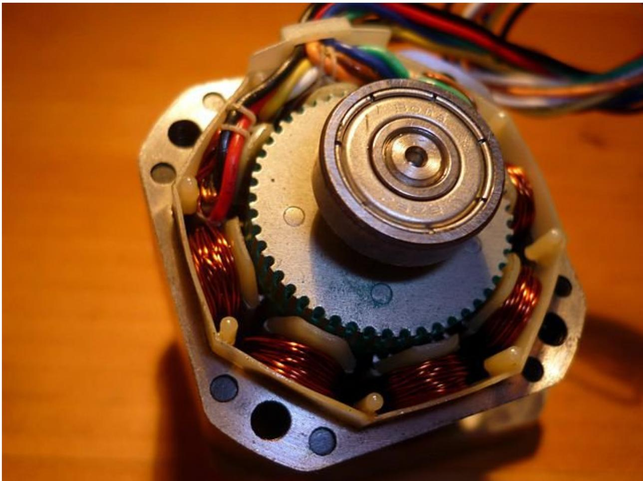
FIGURE VI.3.3. – Vue en coupe d'un moteur pas-à-pas bipolaire - (CC-BY-SA, [vincenzov.net](http://vincenzov.net) )
