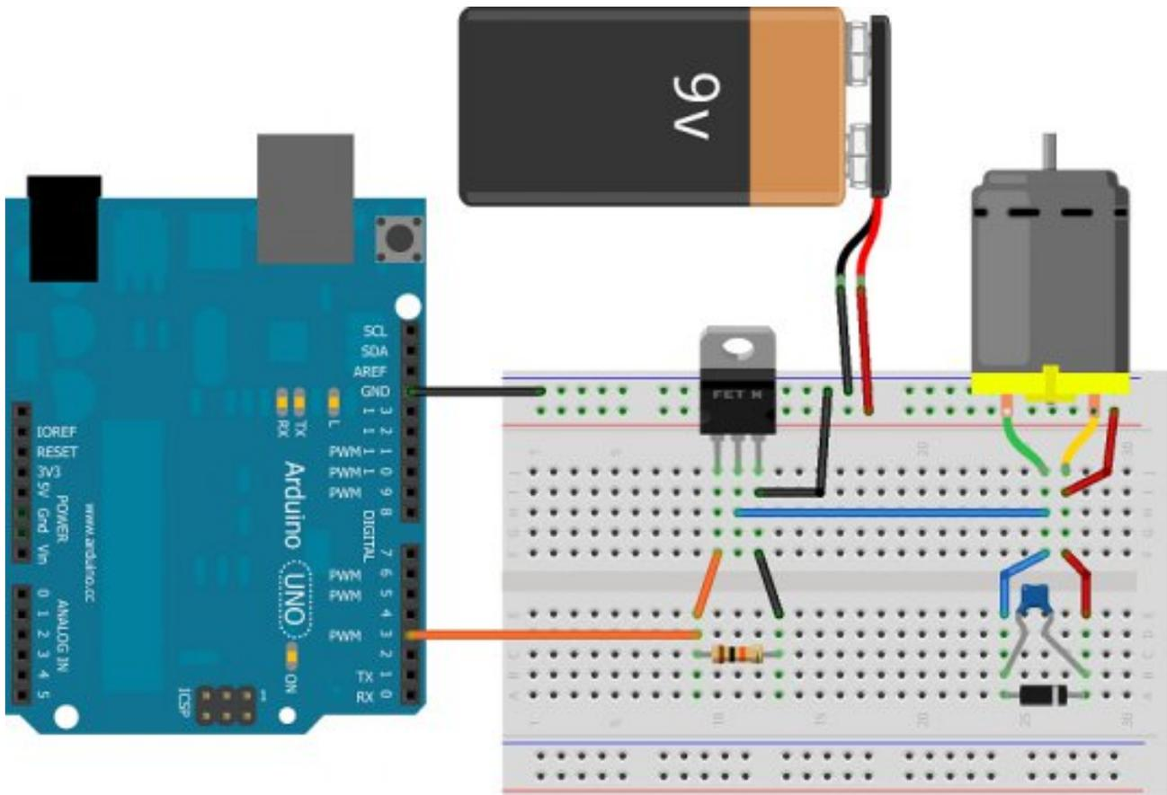
FIGURE VI.1.34. – Montage complet du moteur CC
