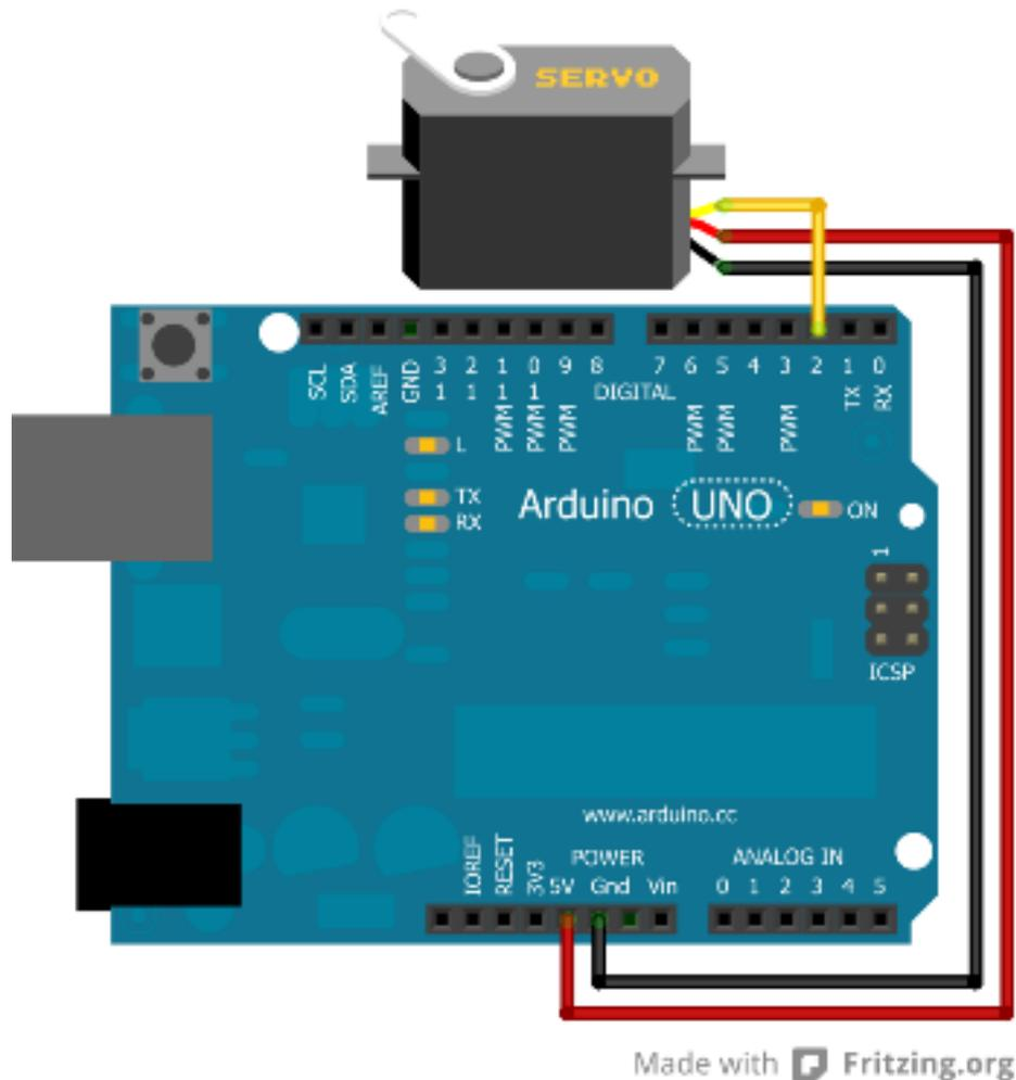
FIGURE VI.2.10. – Montage simple d'un servomoteur avec l'Arduino
