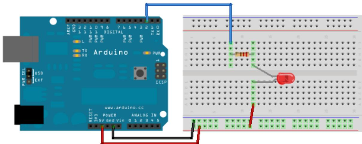
FIGURE II.1.10. – Montage une LED sur breadboard
