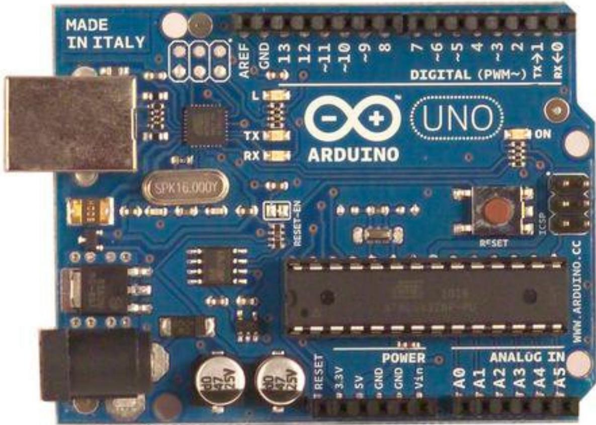
FIGURE I.1.7. – Carte Arduino Uno - (CC-BY-SA, [arduino.cc](http://arduino.cc) ↗ )
