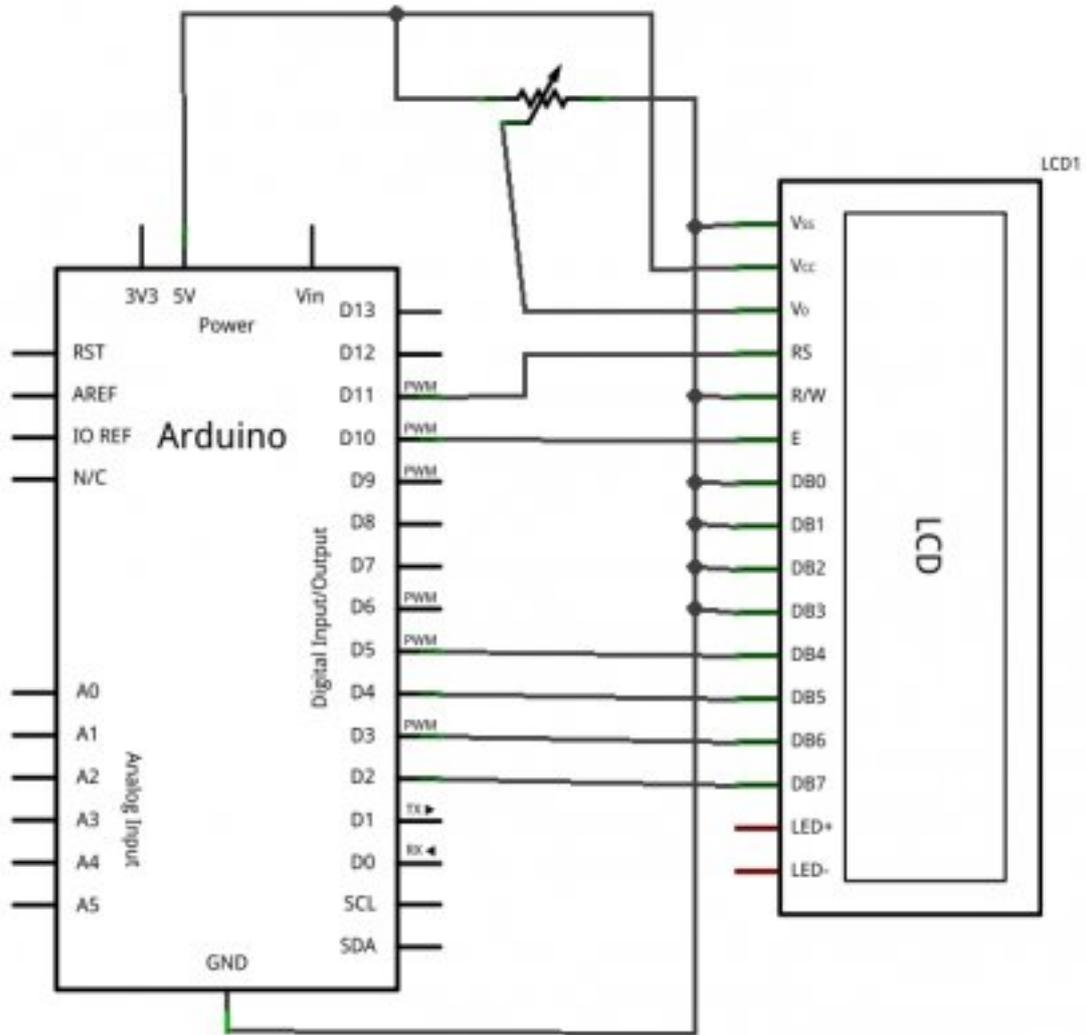
FIGURE VII.1.6. – Branchement du LCD avec 4 fils de données
