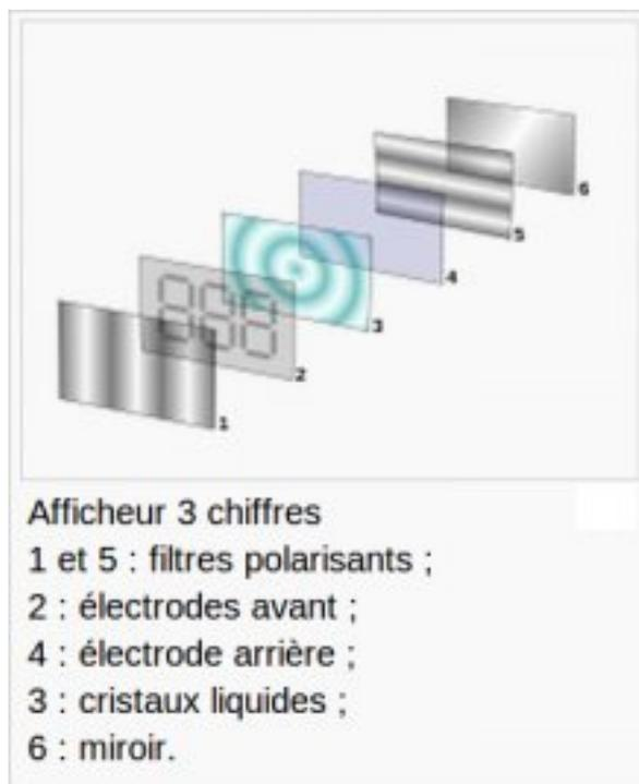
FIGURE VII.1.1. – Composition d'un écran LCD - (CC-BY, [ed g2s](#) )
