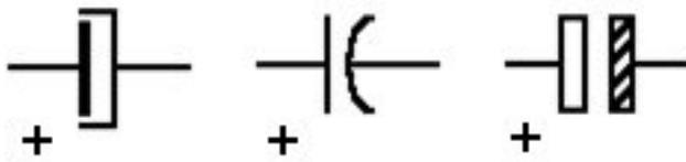
est constitué de deux plaques métalliques, des **armatures**, posées face à face et isolées par... un isolant ! Donc, en somme le condensateur est **équivalent** à un interrupteur ouvert puisqu'il n'y a pas de courant qui peut passer entre les deux armatures. Chaque armature sera mise à un potentiel électrique. Il peut être égal sur les deux armatures, mais l'utilisation majoritaire fait que les deux armatures ont un potentiel différent.
