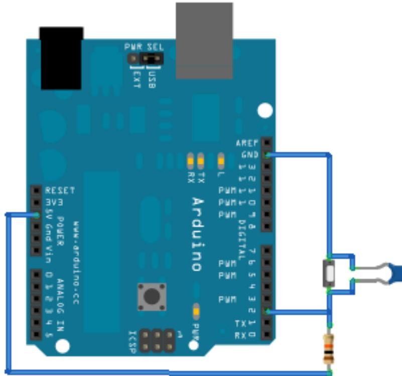
FIGURE II.4.6. – Un bouton + résistance pullup - Montage
