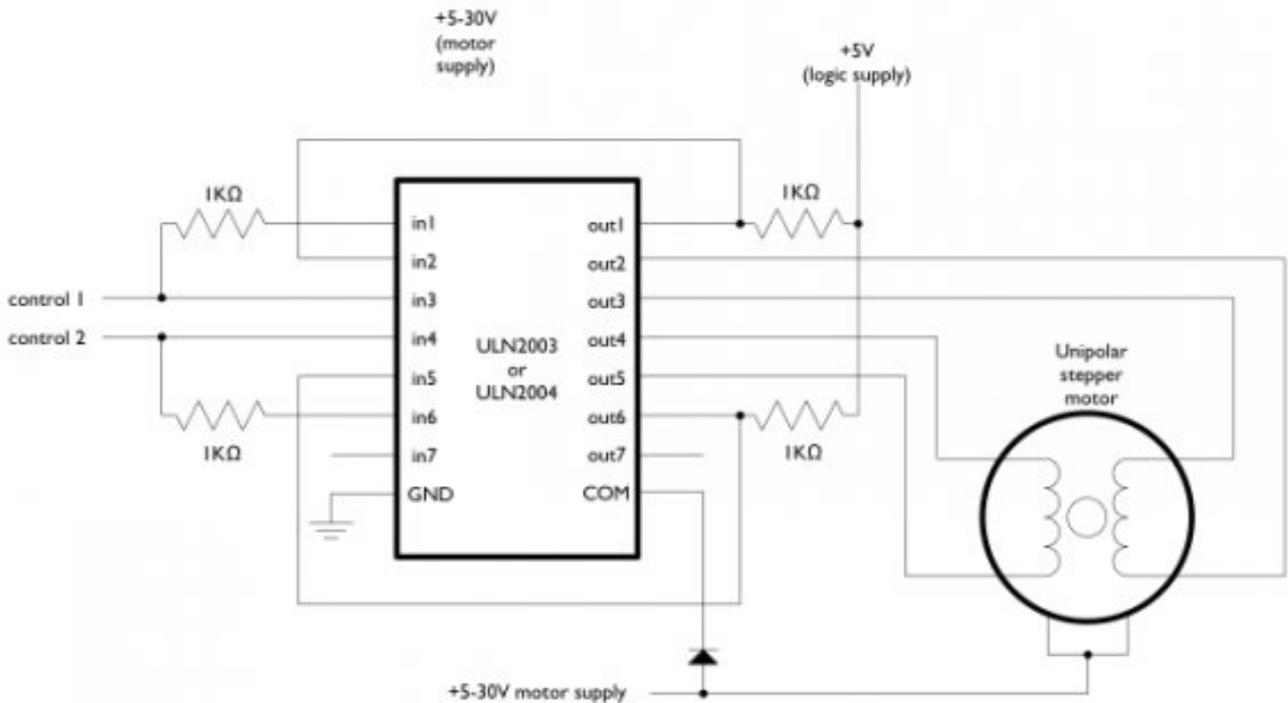
FIGURE VI.3.27. – Moteur unipolaire avec 2 fils
