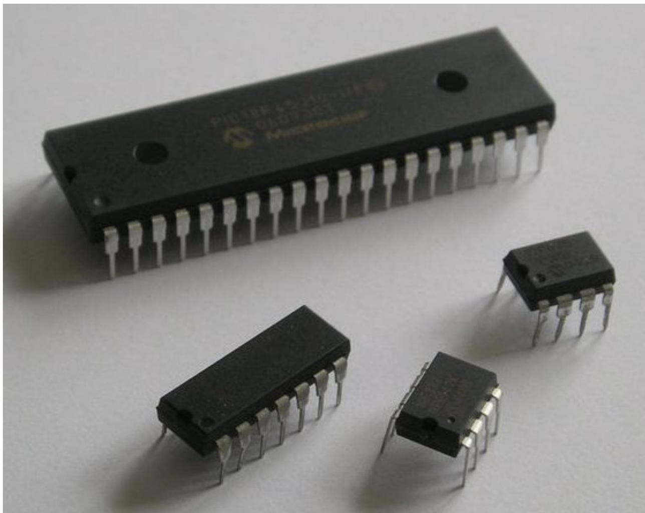
FIGURE I.2.6. – Des microcontrôleurs de différentes tailles (licence CC-0)
