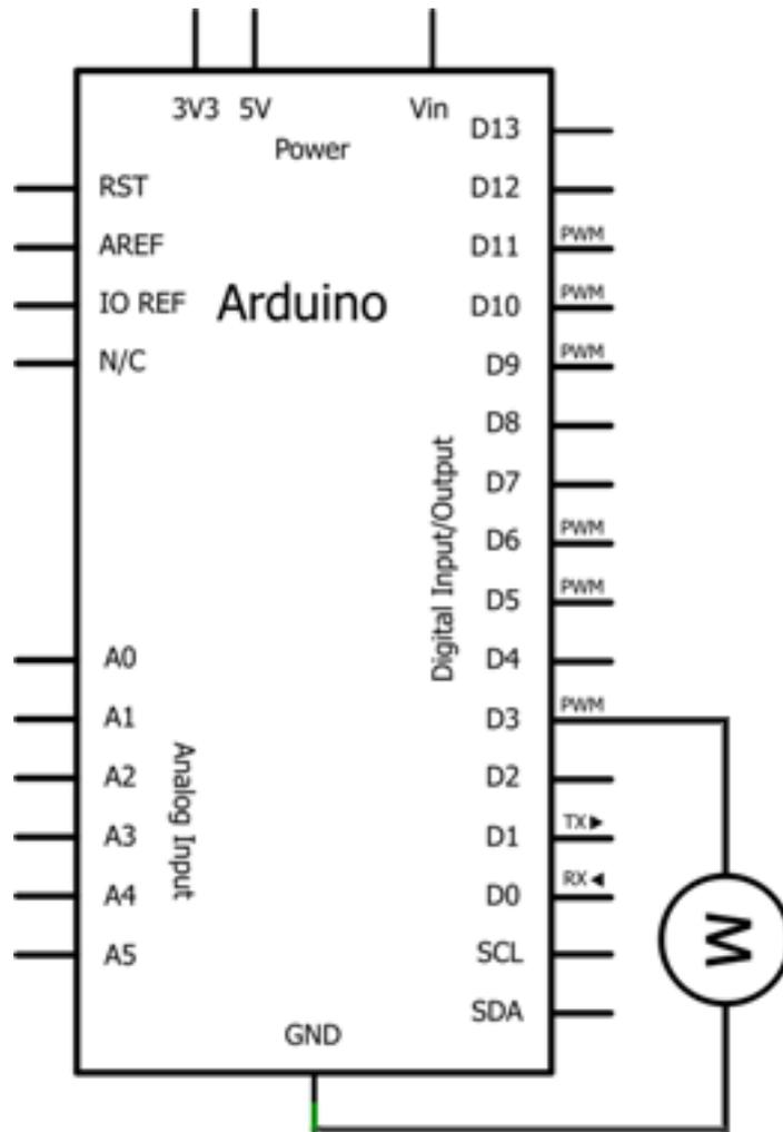
FIGURE VI.1.25. – Moteur branché sur une sortie de l'Arduino
