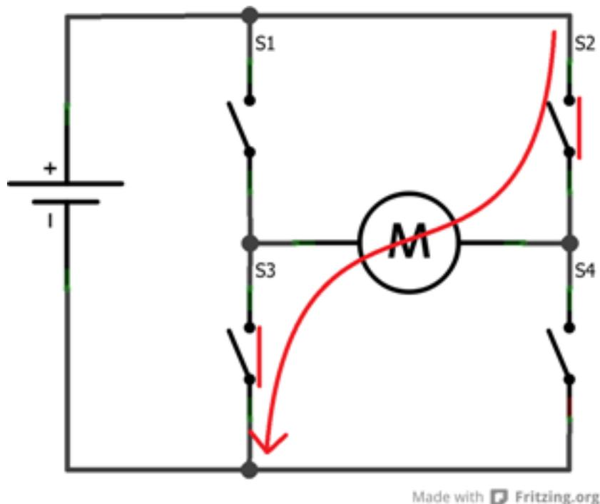
FIGURE VI.1.37. – Fonctionnement dans le sens anti-horaire
