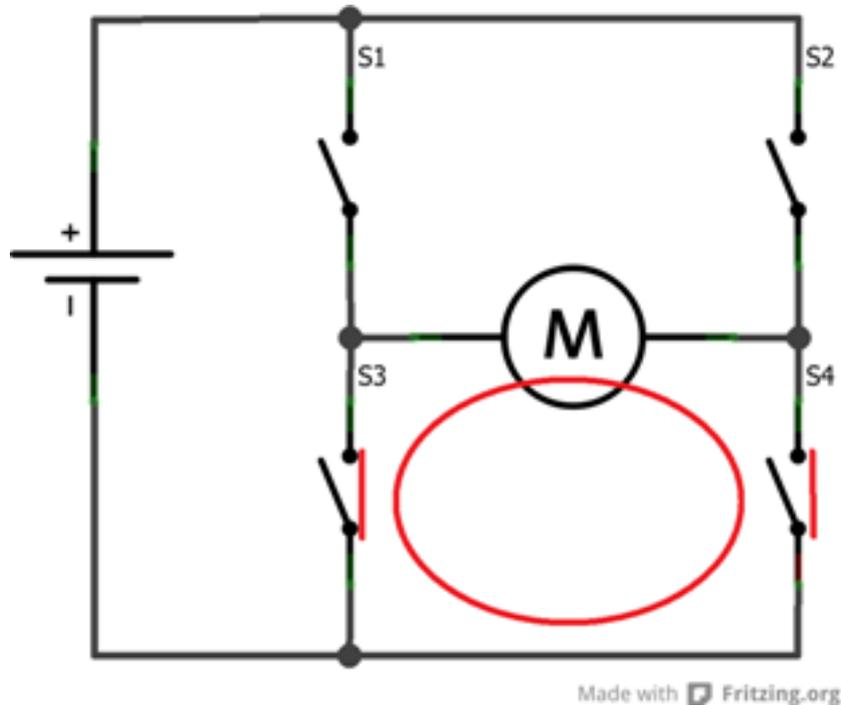
FIGURE VI.1.39. – Freinage avec 3 & 4
