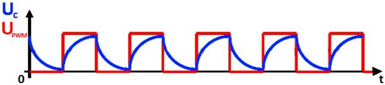
FIGURE IV.3.12. – Charge et décharge successive
