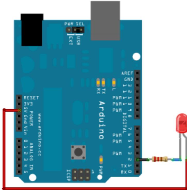
FIGURE II.1.8. – Montage avec une LED et sans breadboard
