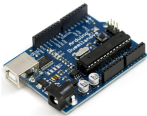
FIGURE I.1.11. – Carte Arduino Duemilanove - (CC-BY-SA, [arduino.cc](http://arduino.cc) ↗ )
