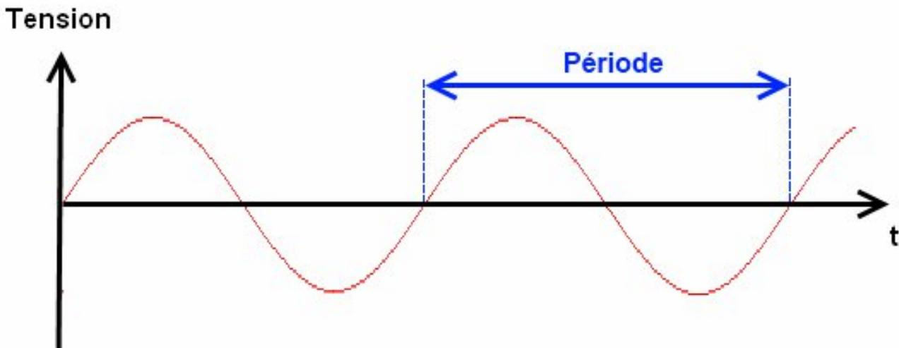
FIGURE IV.1.3. – Période d'un signal analogique
