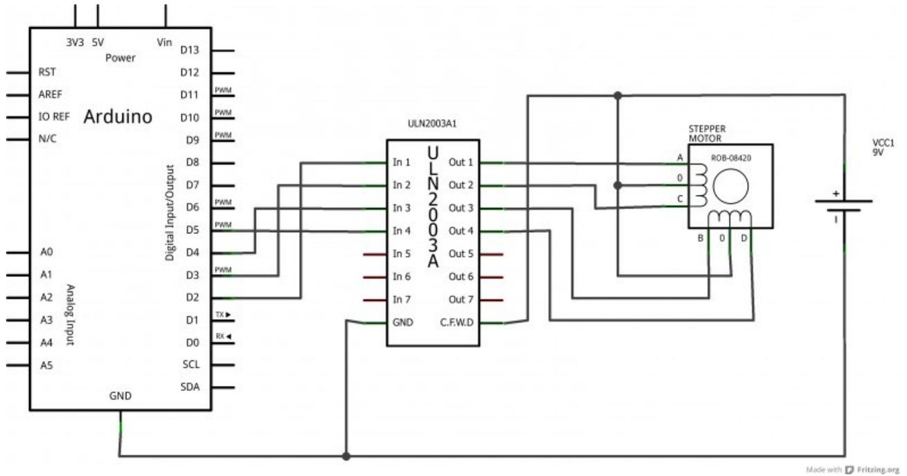
FIGURE VI.3.22. – Câblage du moteur unipolaire - Schéma
