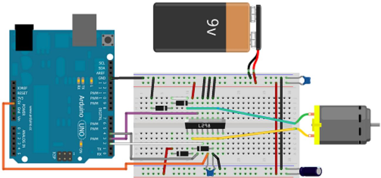
FIGURE VI.1.48. – Montage du L298 avec un moteur et ses diodes
