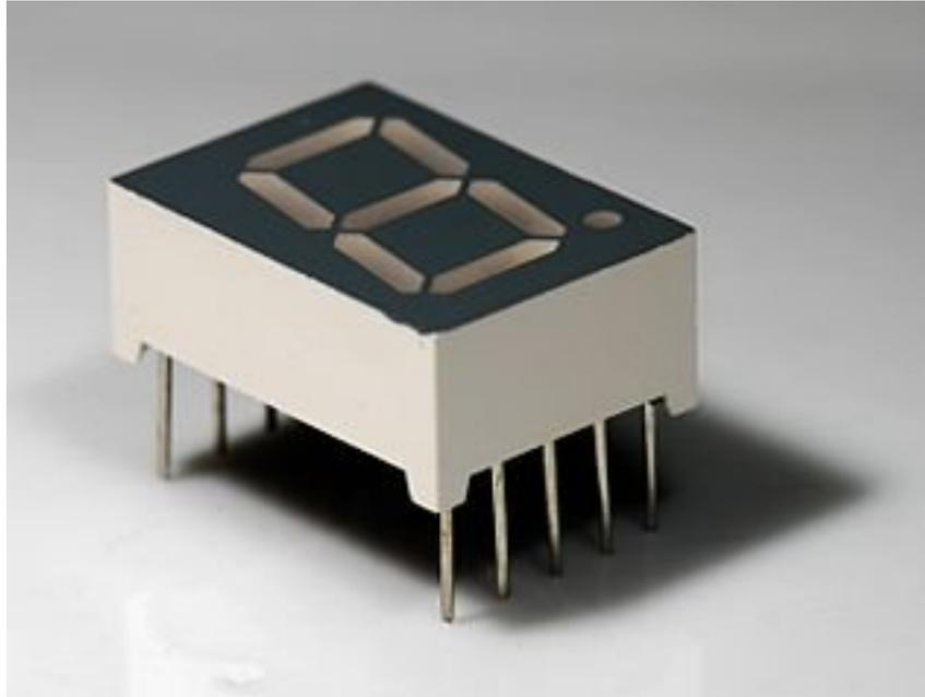
FIGURE II.5.1. – Un afficheur 7 segments - (CC-BY-SA, [Pengo](#) )
