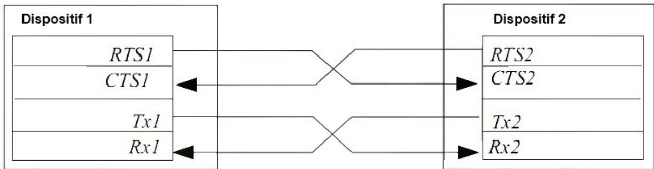
FIGURE III.1.15. – Connexion avec contrôle de flux
