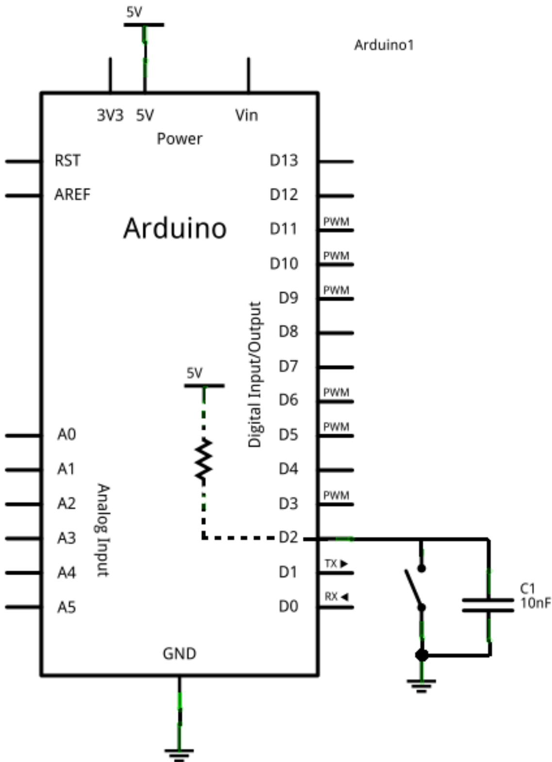
FIGURE II.4.7. – Un bouton + résistance pullup interne - Schéma
