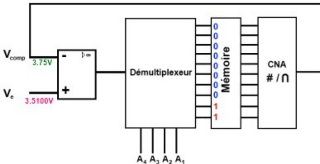
FIGURE IV.1.11. – Chaîne de fonctionnement du CAN - Exemple - Etape 2
