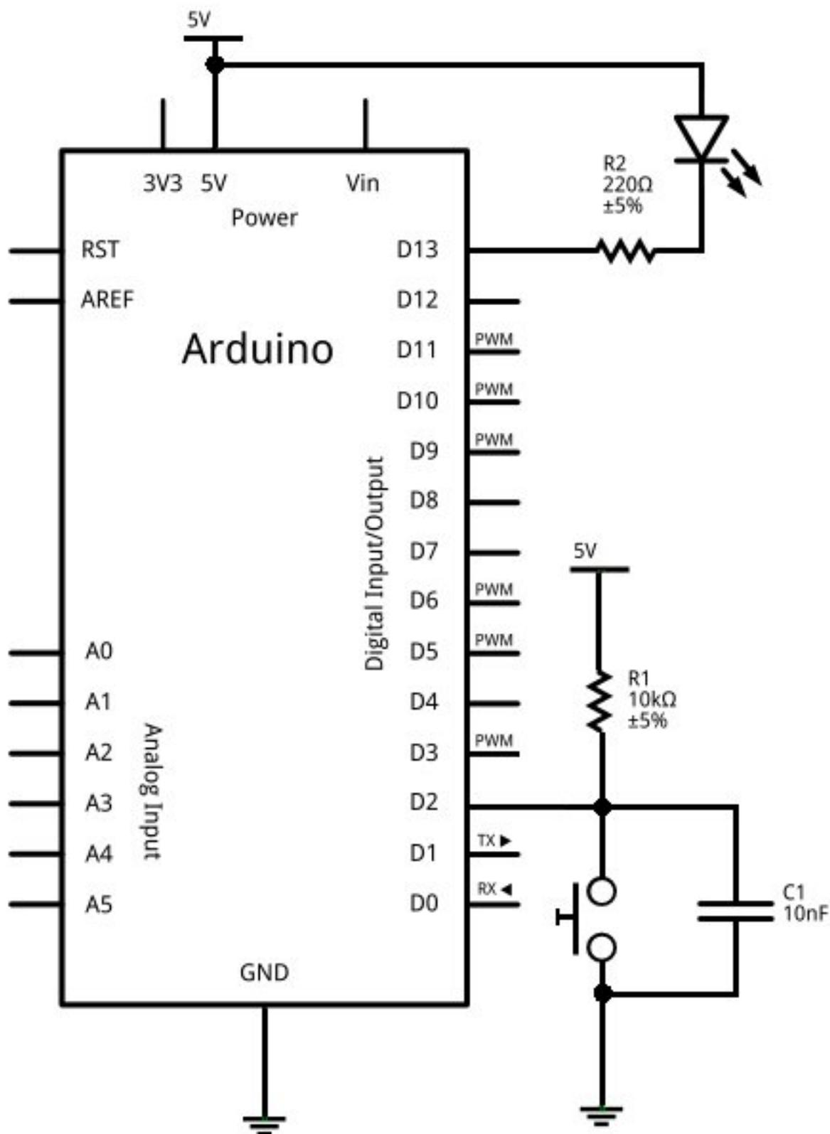
FIGURE II.4.9. – Un bouton et une LED - Schéma
