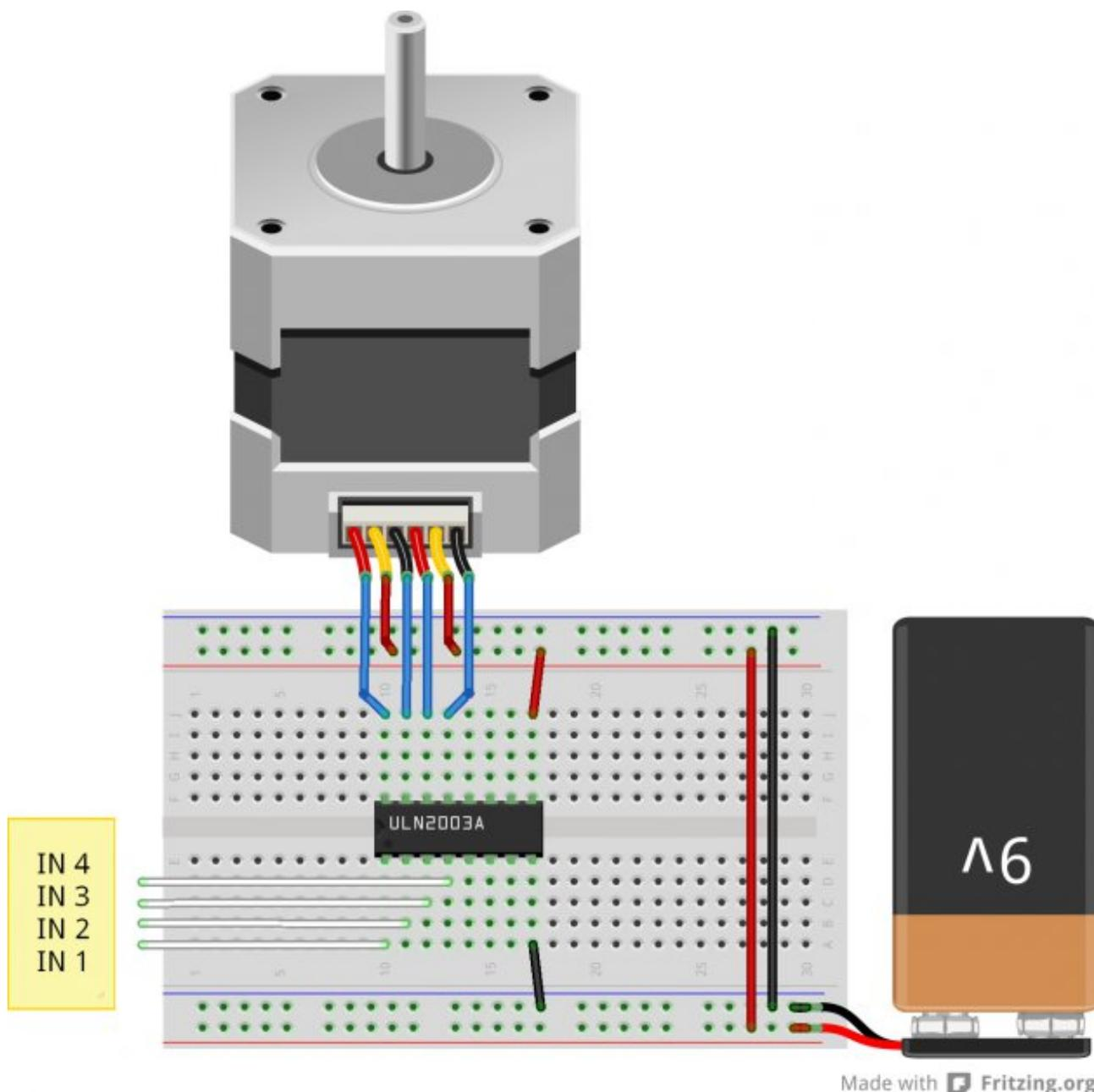
FIGURE VI.3.9. – Câblage simple du moteur unipolaire - Montage
