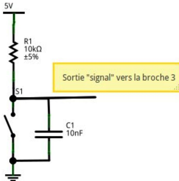
FIGURE II.4.4. – Filtre anti-rebond
