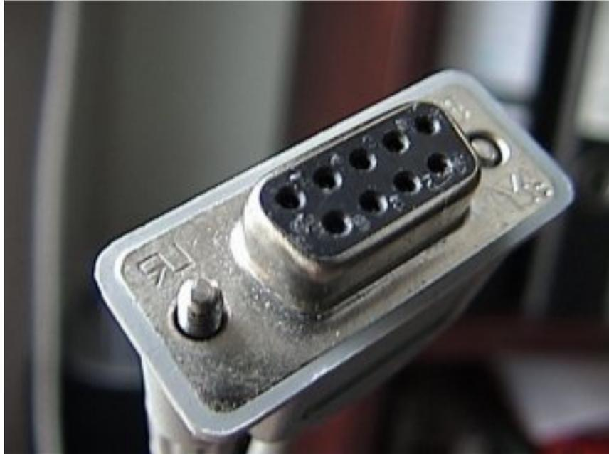
FIGURE III.1.11. – Connecteur DB9 Femelle - (CC-BY-SA, [Faxe ↗](#) )
