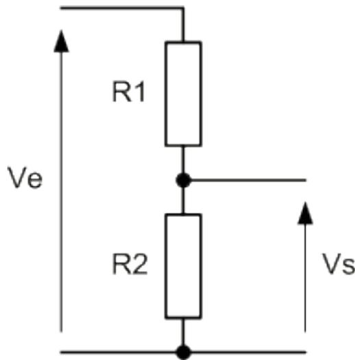
FIGURE V.2.9. – Pont diviseur de tension
