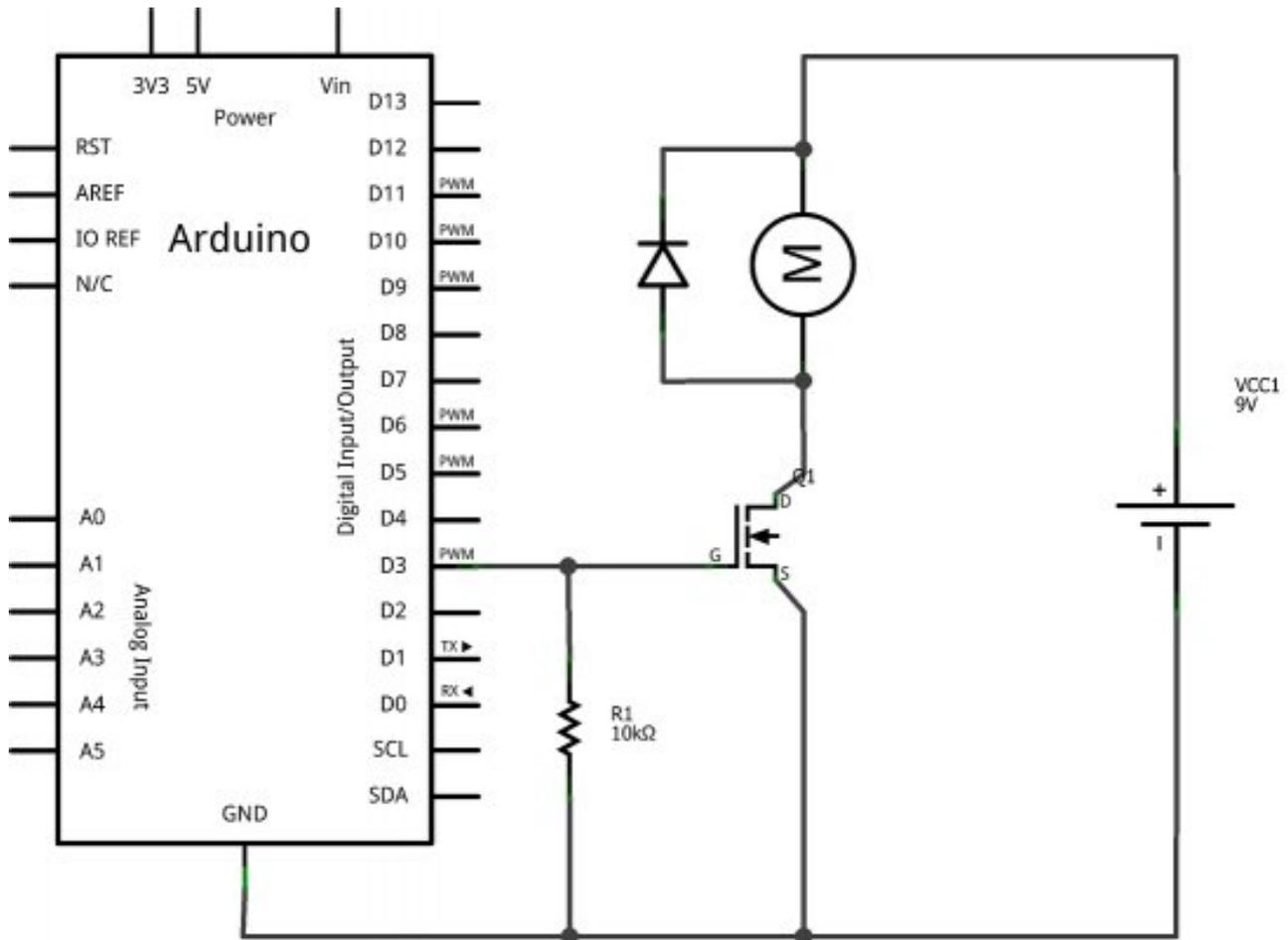
FIGURE VI.1.30. – Schéma d'utilisation de la diode
