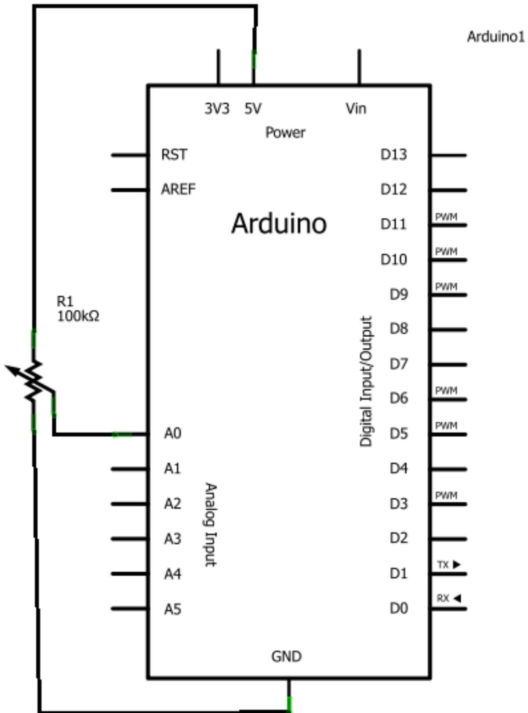
FIGURE IV.1.15. – Potentiomètre - Schéma
