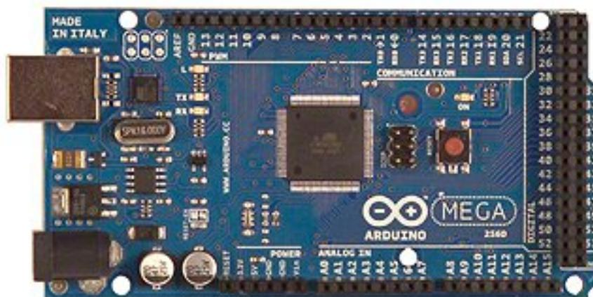
FIGURE I.1.13. – Carte Arduino Mega - (CC-BY-SA, [arduino.cc](https://arduino.cc) [↗](#) )
