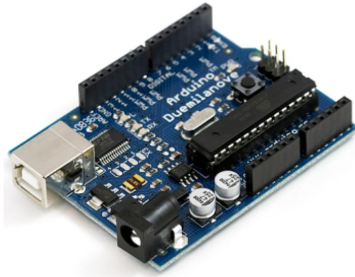
FIGURE I.1.2. – Carte Arduino Duemilanove - (CC-BY-SA, [arduino.cc](http://arduino.cc) )
