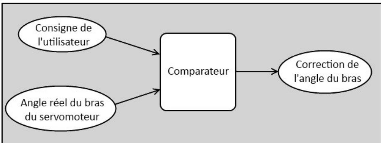
FIGURE VI.2.6. – Synoptique de fonctionnement de l'asservissement du servomoteur
