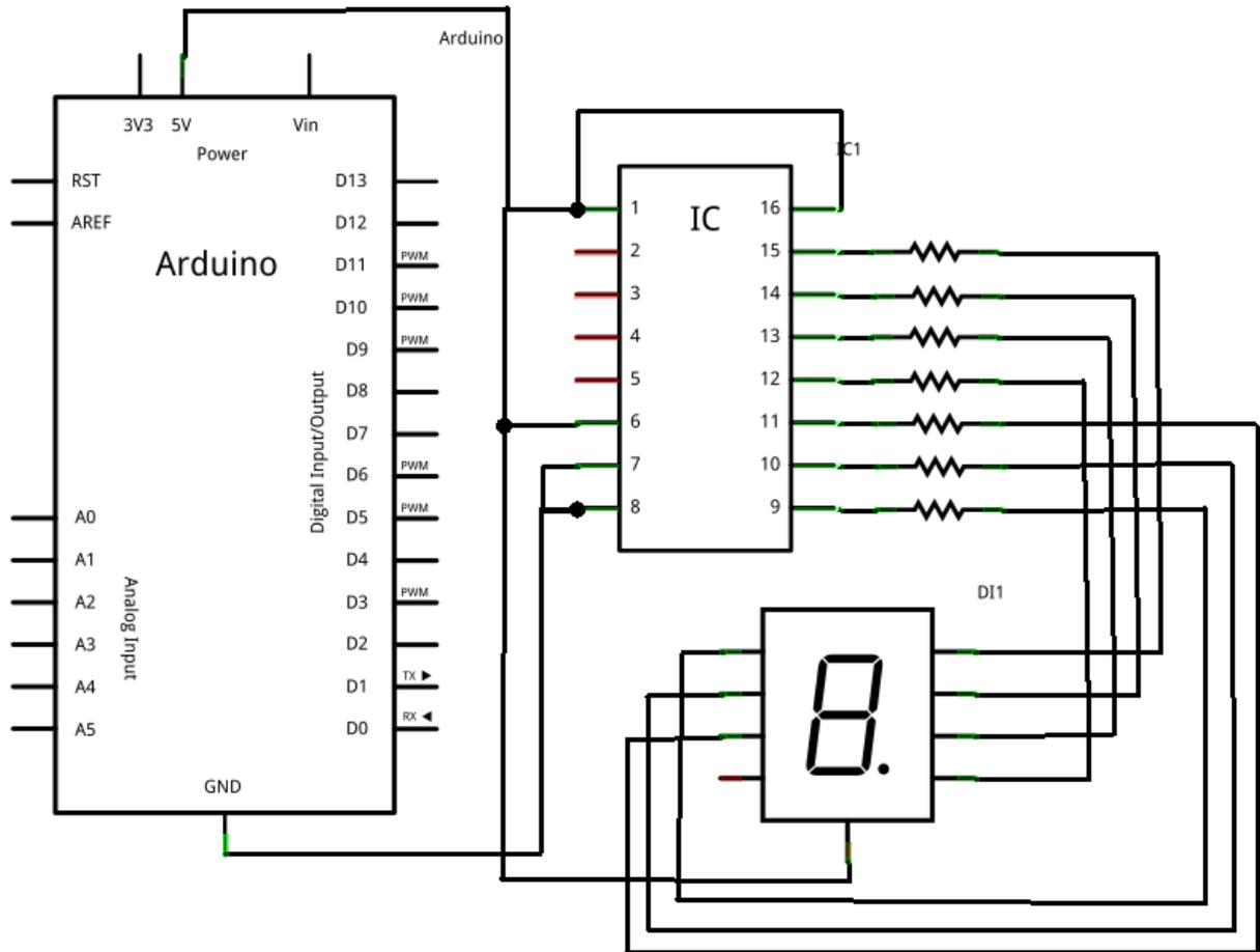
FIGURE II.5.19. – Montage 7 segments - Schéma
