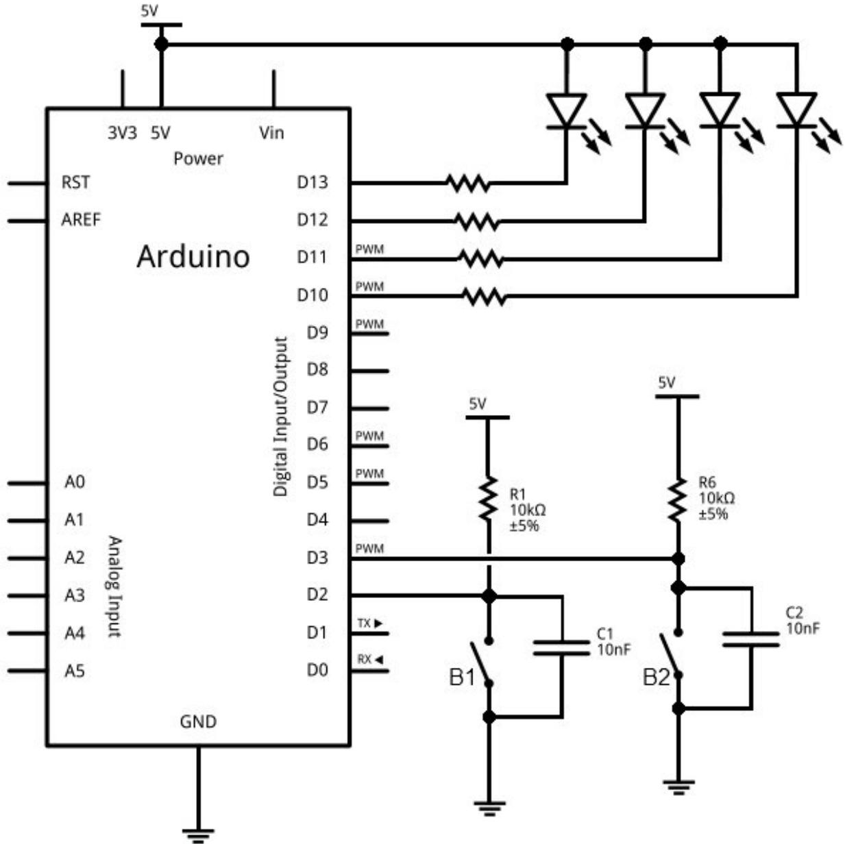
FIGURE II.4.11. – Deux boutons et quatre LED - Schéma
