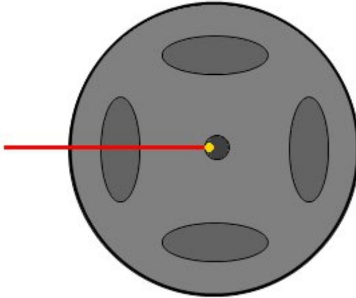
FIGURE VI.1.16. – Marquage de l'axe du moteur par un point jaune
