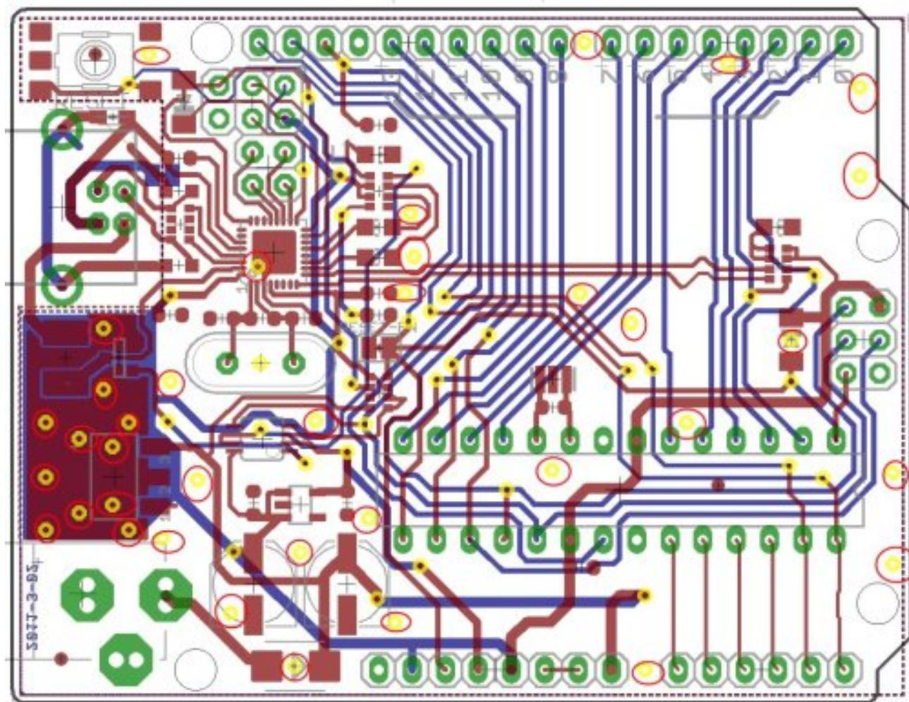
FIGURE I.1.4. – Exemple de typon - carte Arduino - (CC-BY-SA, [arduino.cc](https://arduino.cc) ↗)
