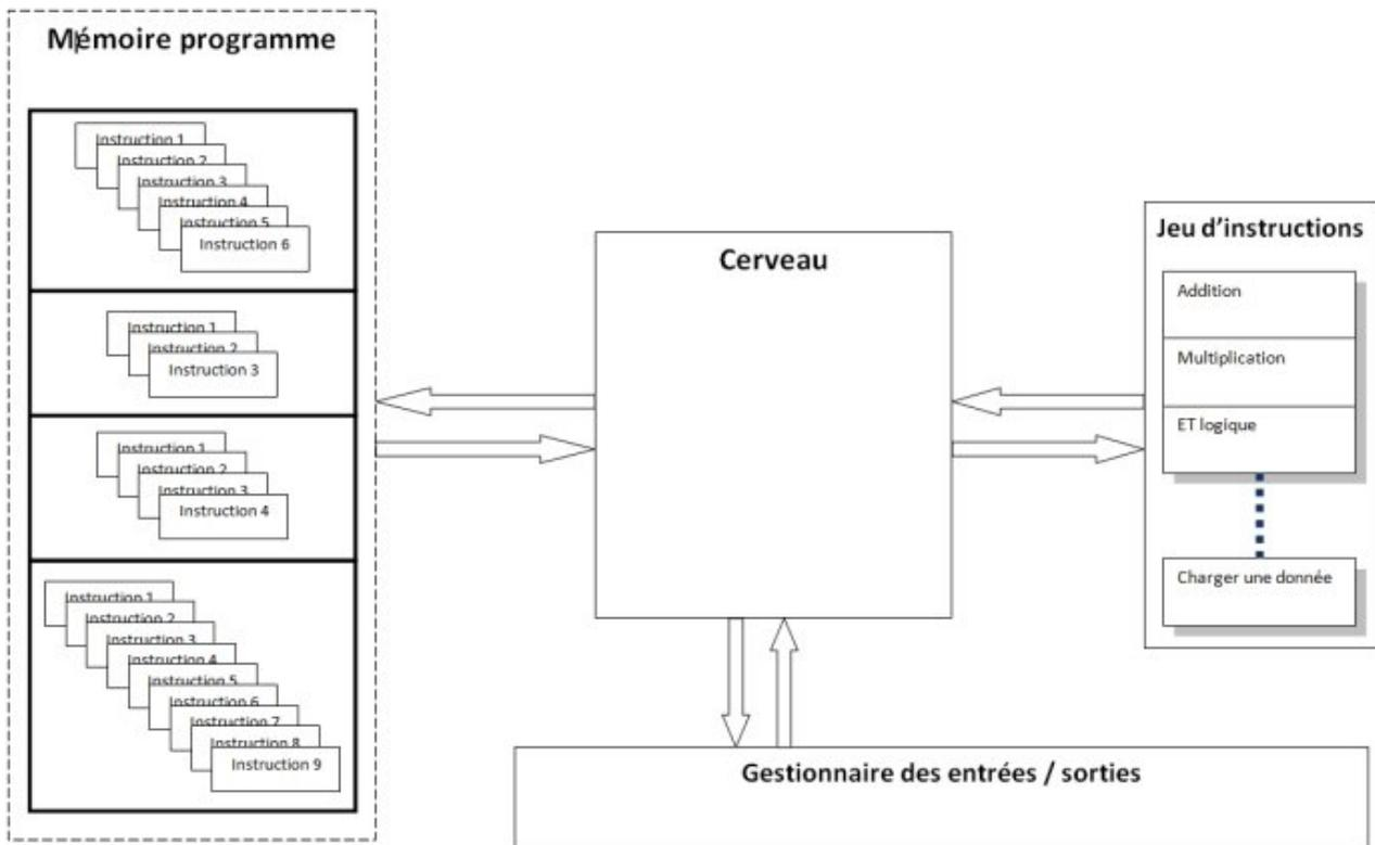
FIGURE II.1.16. – Interaction entre les éléments du microcontrôleur
