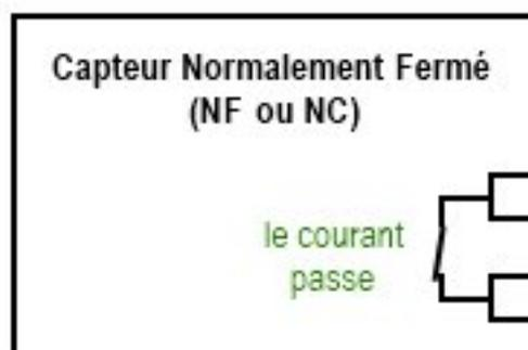
FIGURE V.2.2. – Schéma d'un capteur normalement fermé
