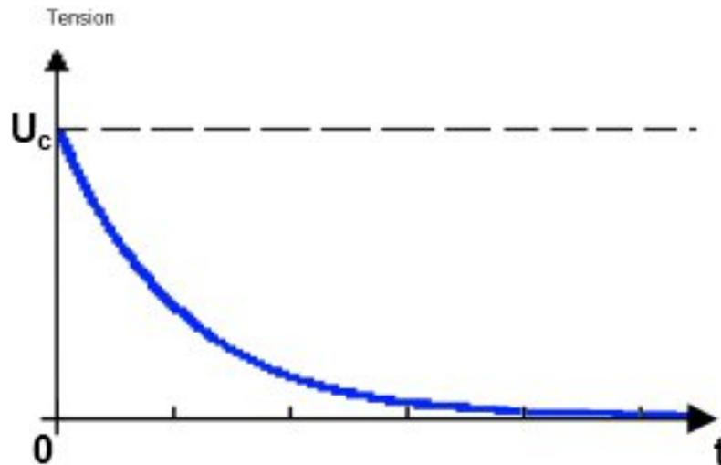
FIGURE IV.3.11. – La courbe de décharge d'un condensateur
