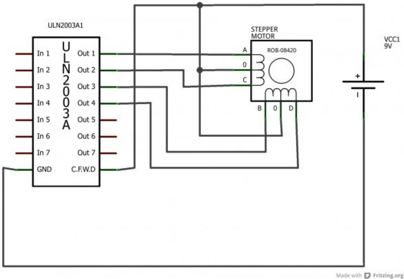
FIGURE VI.3.8. – Câblage simple du moteur unipolaire - Schéma
