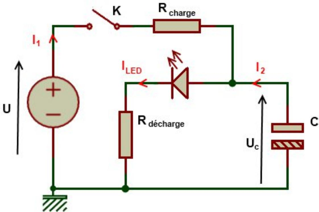
FIGURE IV.3.9. – Un couple RC en action
