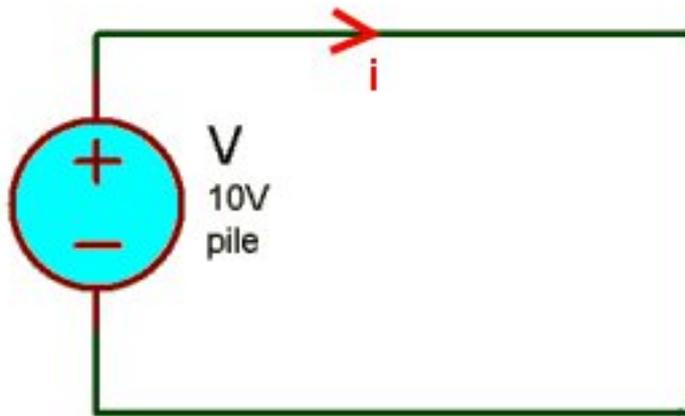
FIGURE I.2.1. – Indication du sens du courant
