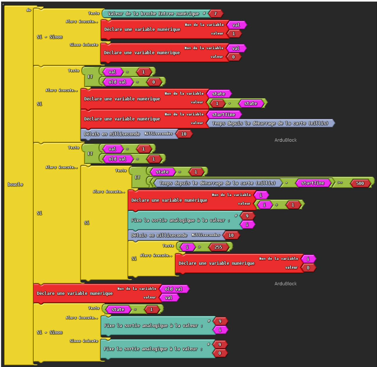
FIGURE I.1.8. – Exemple de programme avec ArduBlock
