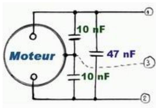
FIGURE VI.1.42. – Un peu de découplage, schéma
