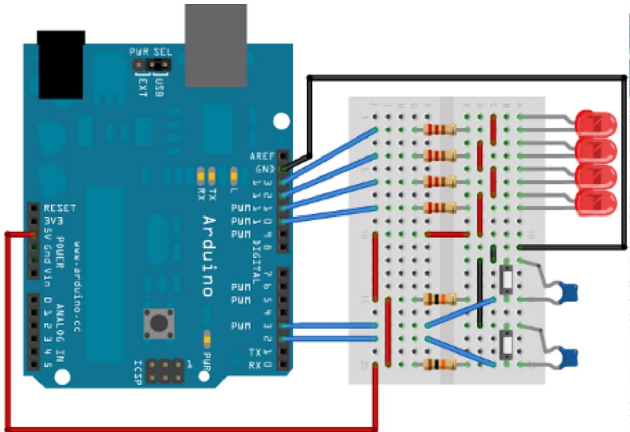
FIGURE II.4.12. – Deux boutons et quatre LED - Montage
