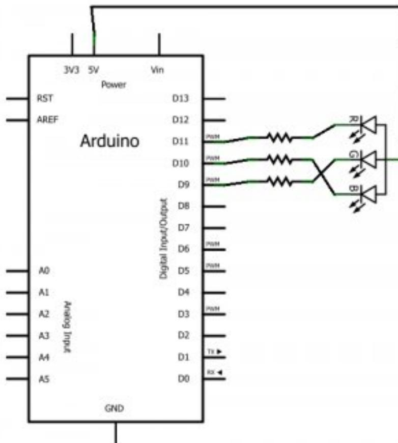
FIGURE IV.3.6. – RGB schéma
