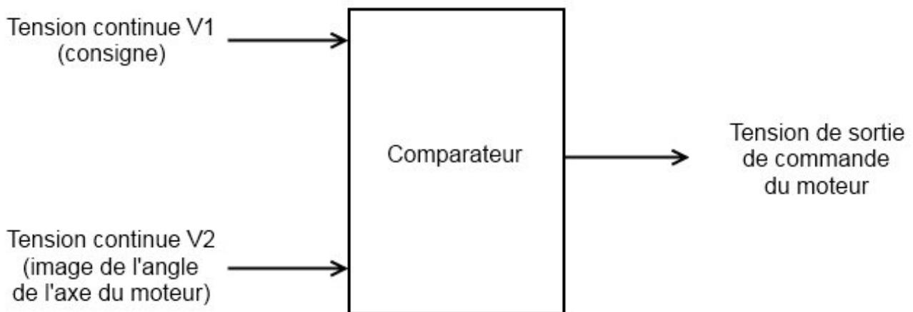
FIGURE VI.2.12. – Fonctionnement de l'électronique de contrôle
