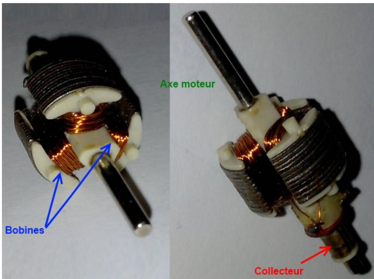
FIGURE VI.1.14. – Rotor d'un moteur à courant continu
