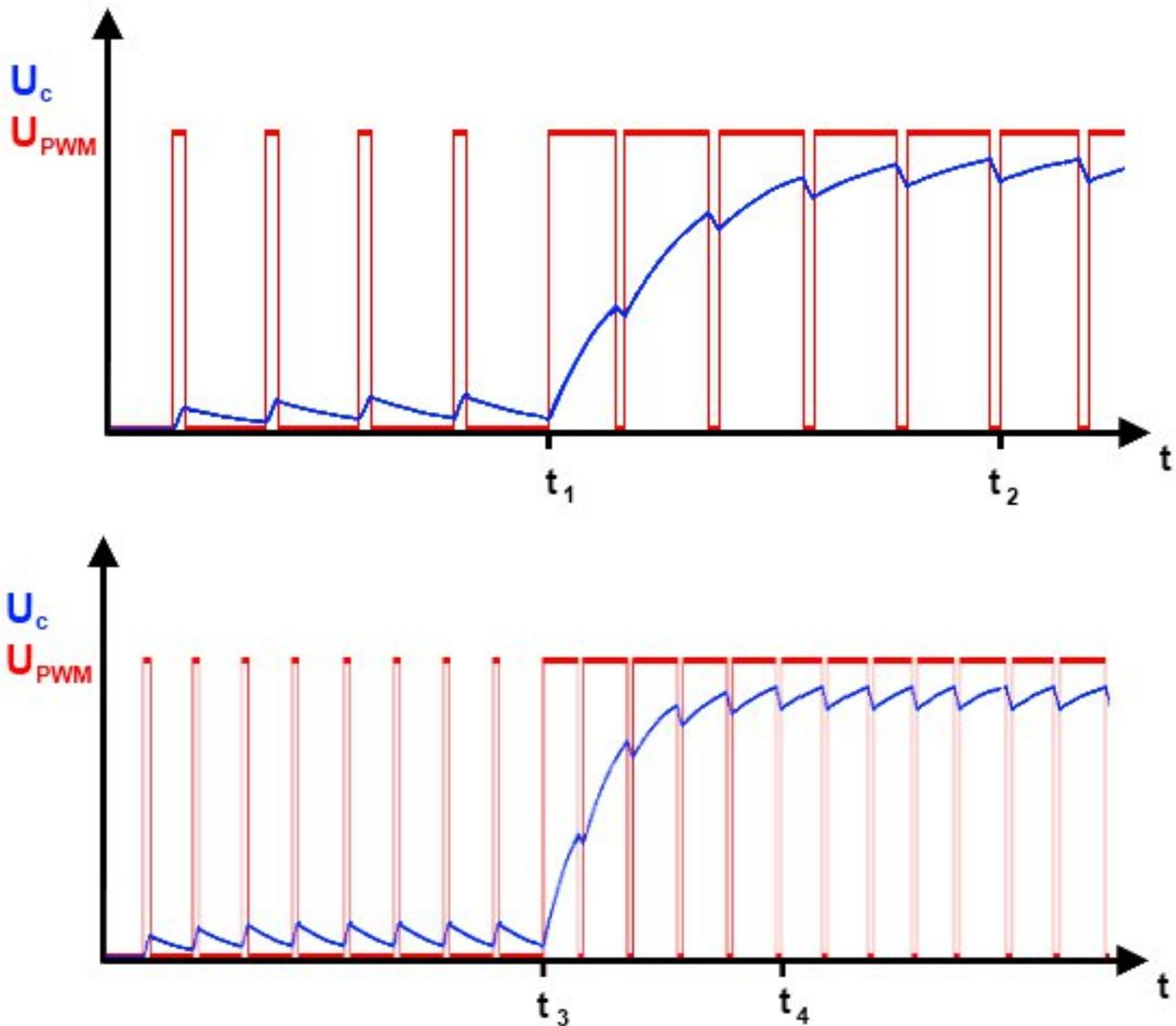
FIGURE IV.3.16. – L'impact de la modification de la PWM
