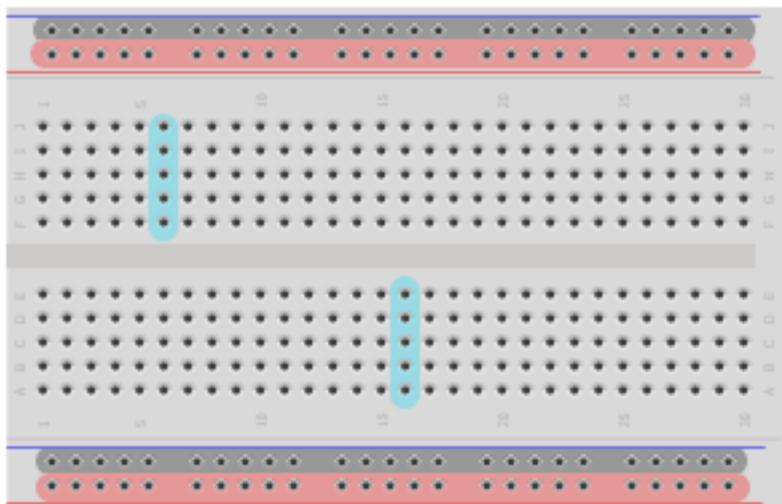
FIGURE II.1.6. – Une breadboard
