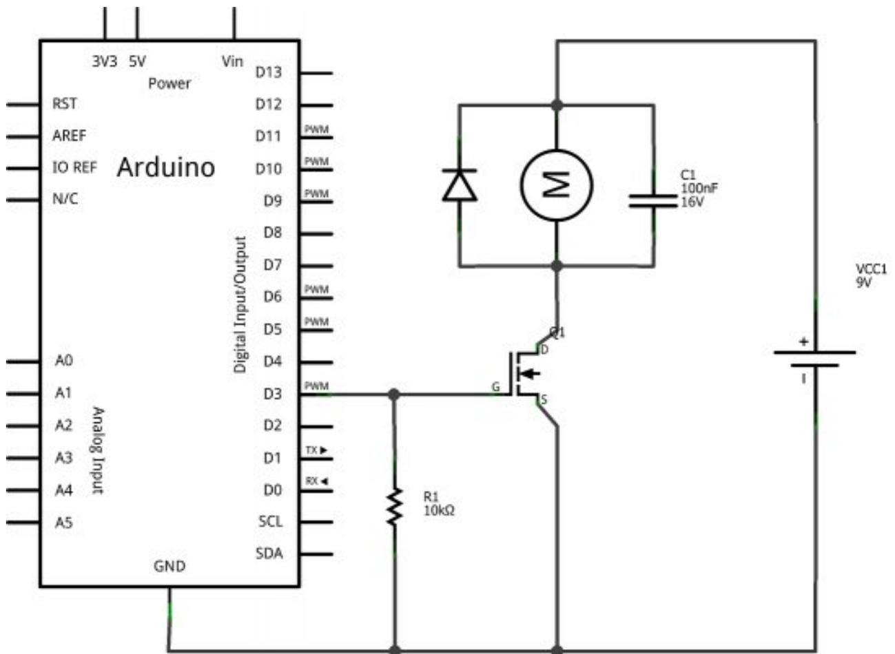
FIGURE VI.1.31. – Schéma du montage complet du moteur CC
