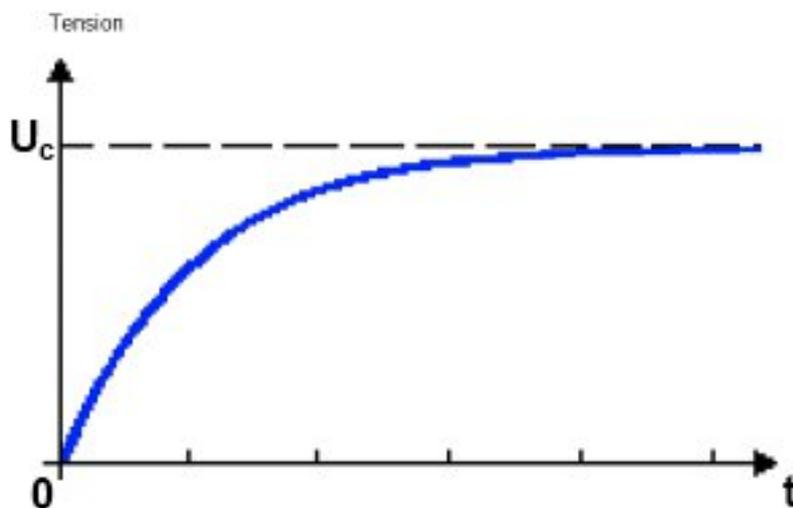
FIGURE IV.3.10. – La courbe de charge d'un condensateur
