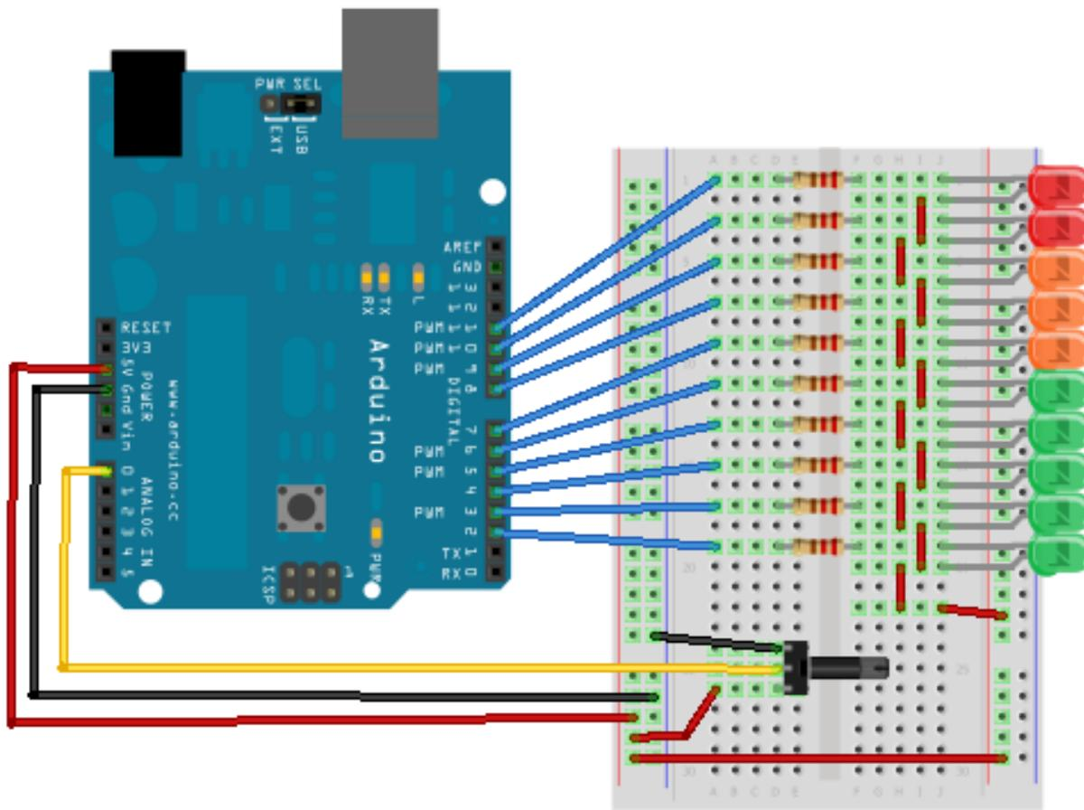
FIGURE IV.2.1. – Vumètre - Montage
