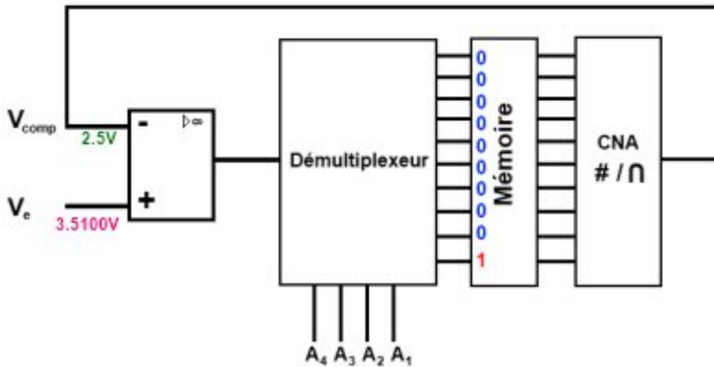
FIGURE IV.1.10. – Chaîne de fonctionnement du CAN - Exemple - Etape 1
