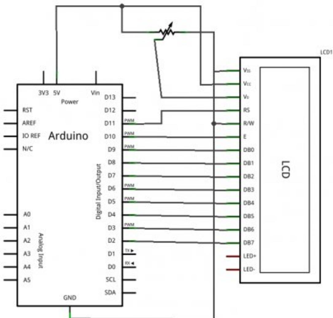
FIGURE VII.1.4. – Branchement du LCD avec fils de données
