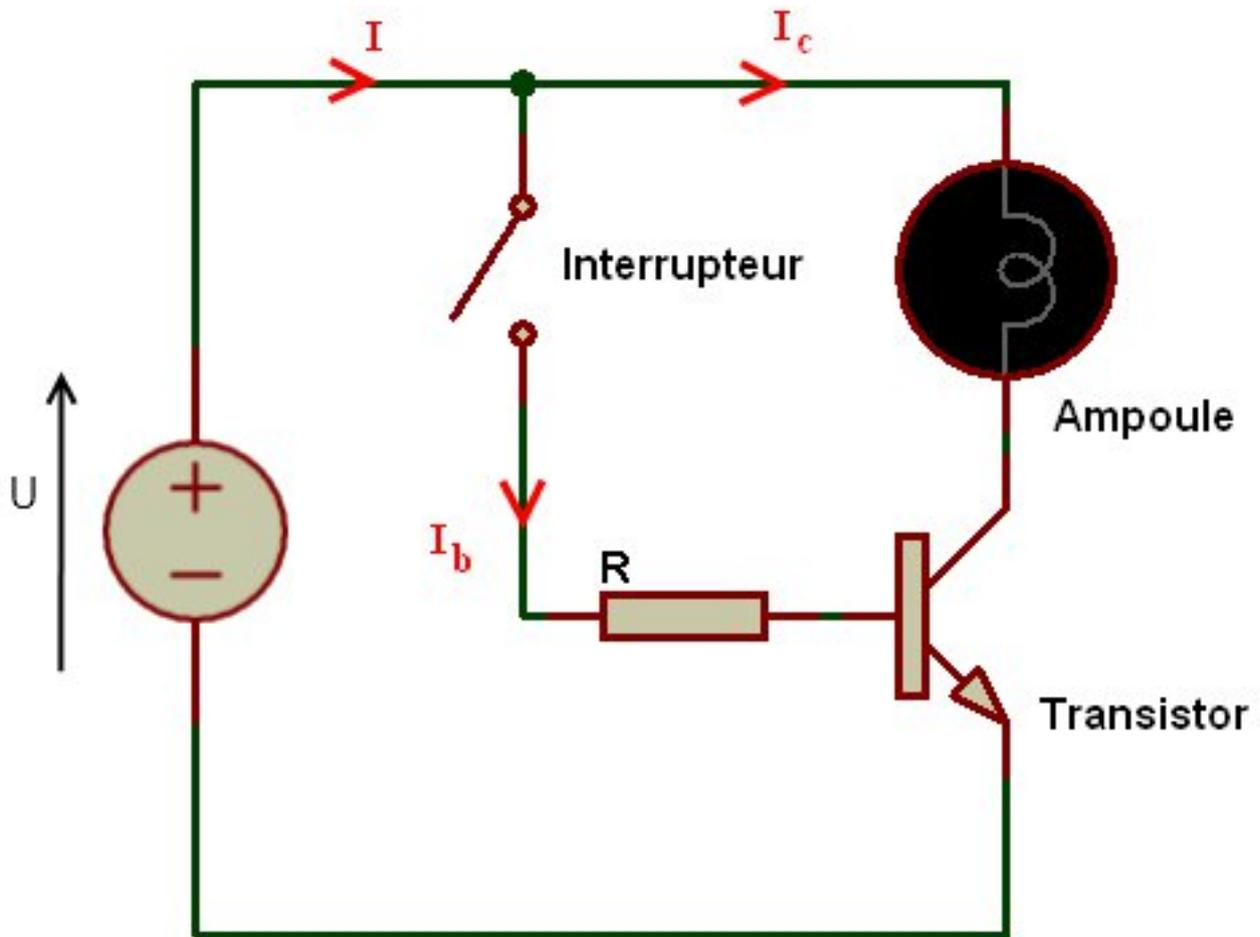
FIGURE II.5.13. – Câblage du transistor en commutation
