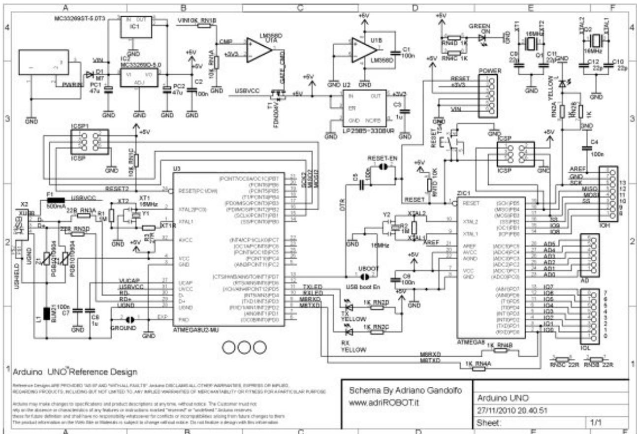
FIGURE I.1.3. – Exemple de schéma électronique - carte Arduino Uno - (CC-BY-SA, [arduino.cc](http://arduino.cc) )
