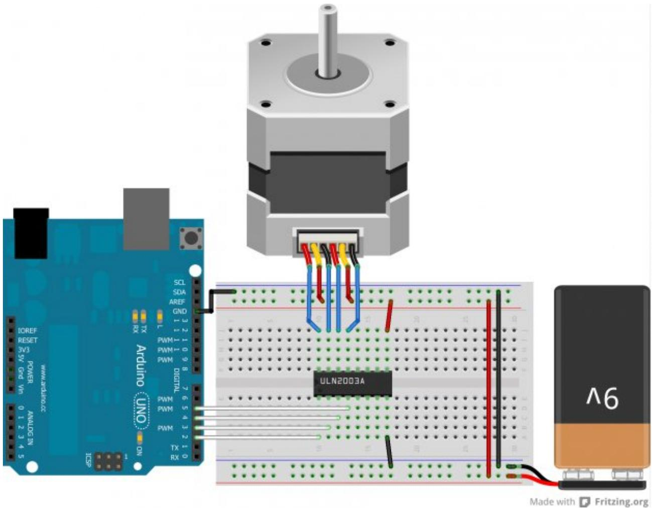
FIGURE VI.3.23. – Câblage du moteur unipolaire - Montage
