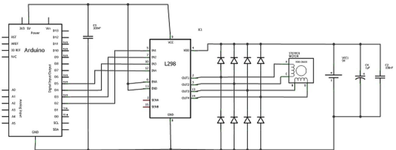
FIGURE VI.3.24. – Câblage du moteur bipolaire - Schéma
