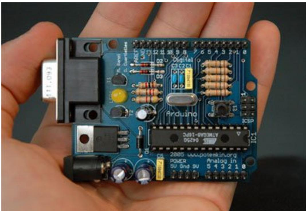
FIGURE III.1.12. – La première version de la carte Arduino, avec un connecteur DB9 - (CC-BY-SA, [arduino.cc](http://arduino.cc) )
