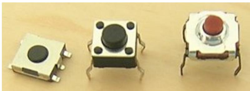
FIGURE II.4.1. – Quelques boutons poussoirs - (CC-BY-SA [Scwerllguy](#) )
