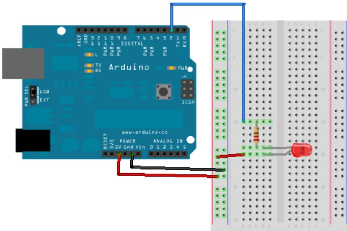
FIGURE II.1.9. – Montage une LED sur breadboard
