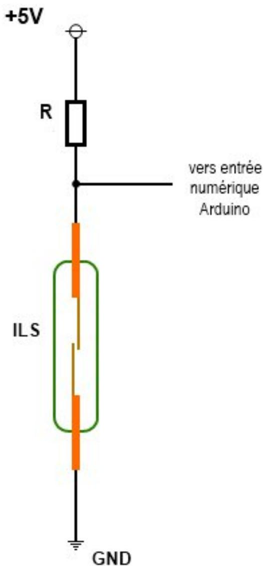
FIGURE V.2.5. – Représentation schématique
