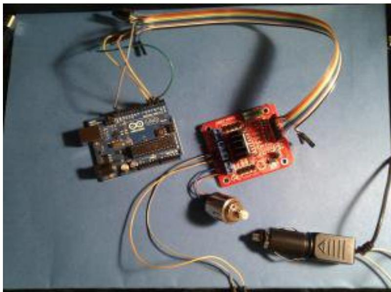
FIGURE VI.1.52. – Le montage avec le shield et Arduino
