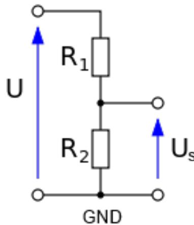
FIGURE IV.1.17. – Schéma du pont diviseur de tension
