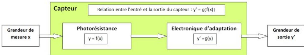
FIGURE V.1.10. – Représentation schématique
