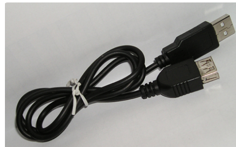
USB-Verlängerungskabel (nicht in der USB-Spezifikation)
