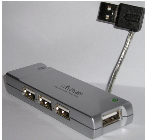
4-Port-USB-Hub mit Stromversorgung aus dem Bus (bus powered)
