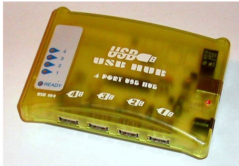
4-Port-USB-Hub mit eigener Stromversorgung (self powered, Netzteilbuchse rechts)
