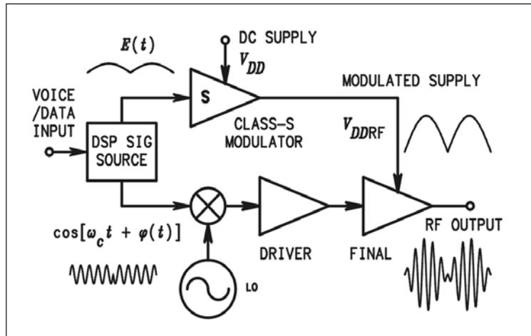
Figure 26 · Kahn-technique transmitter.
