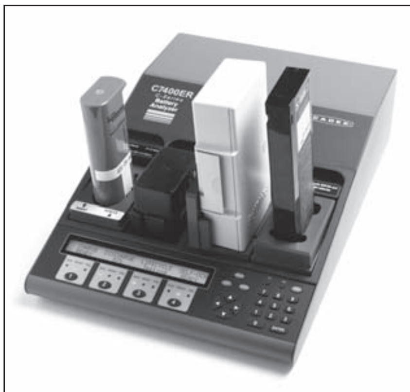
Foto A. El analizador Cedex C7400ER es un buen ejemplo de un analizador de baterías que puede ayudar a determinar el estado de una batería.
