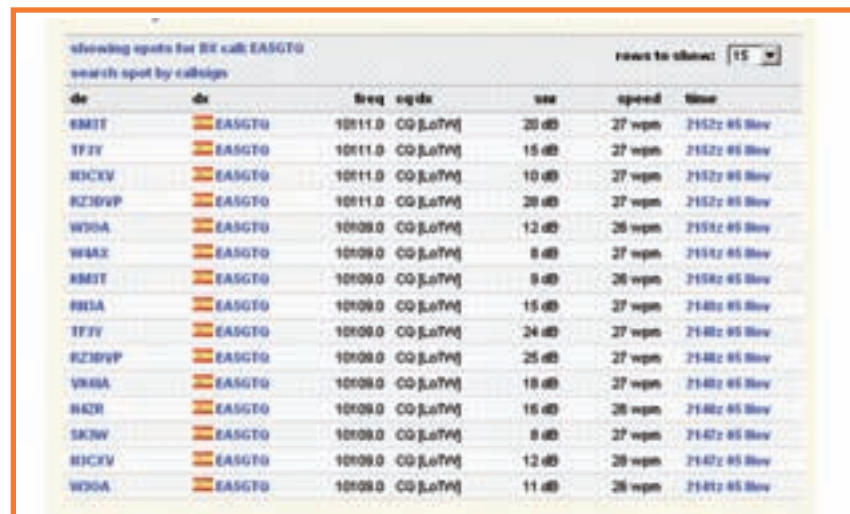
Figura 2. Pantalla de la aplicación Reverse-Beacon. Tras hacer CQ en 30 metros, EA5GTQ puede comprobar inmediatamente en qué receptores de la Red es escuchada su señal. Ese día la apertura de propagación de la banda llegaba desde Australia a Norteamérica.
