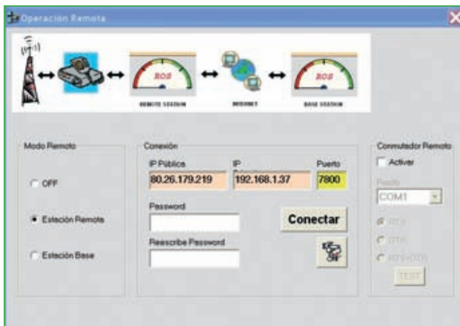
Figura 9 . Configuración de la estación remota
