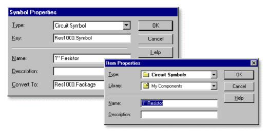
Usando las herramientas de dibujo en en menú Insert|Picture dibujen la forma de un rectángulo y las dos lineas verticales. Luego, seleccionen los tres objetos y desde el menú Edit | Layer seleccionen Circuit Diagram. Esto colocará los tres objetos en la capa o layer que se usa para dibujar diagrama de circuitos eléctricos.
