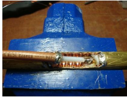
Este cable de alimentación bajara por dentro del tubo del soporte vertical y en su extremo soldaremos el conector que será el punto donde tomemos el cable de bajada hasta el equipo. En mi caso soldé un conector N hembra panel **NOTA: no soldar el conector hasta que no pasemos el cable y el caño por el soporte vertical.**
