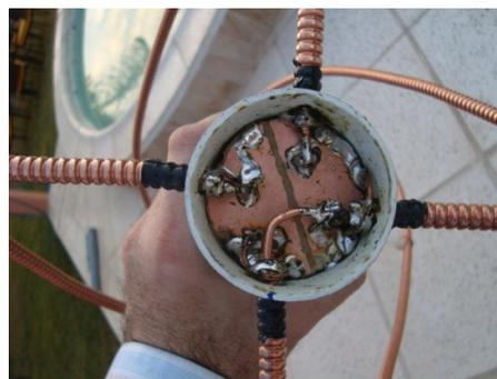
De esta forma la antena estaría terminada en lo que a la parte técnica se refiere, ahora tenemos que medirla para saber si esta todo ok, mediante un TX de VHF y un roimetro procedemos a medirla, debiéramos obtener una medición muy aceptable digamos valores por debajo de 1,5:1.
