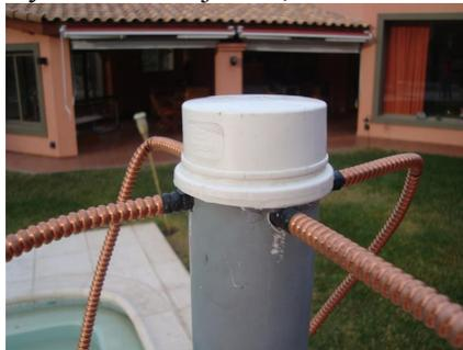
Recuerde que por el tipo de lobulote irradiación de esta antena y para la recepción de satélites, no necesitamos instalarla a gran altura, solo necesitamos que tenga despeje a los horizontes, en mi caso la instale a 3 metros en una baranda en la terraza, y cubro la pasada de los NOAA desde tierra del Fuego hasta Perú. Con señales excelentes.
