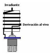
**IMPORTANTE:** Nótese el detalle de montaje y que la parte inferior de la bobina va conectada a la masa del conector. *El vivo del mismo va a una derivación de la bobina tomada a 1 vuelta y media desde la base.*
