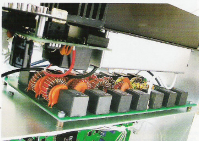
Der Automatiktuner ist senkrecht eingebaut.
