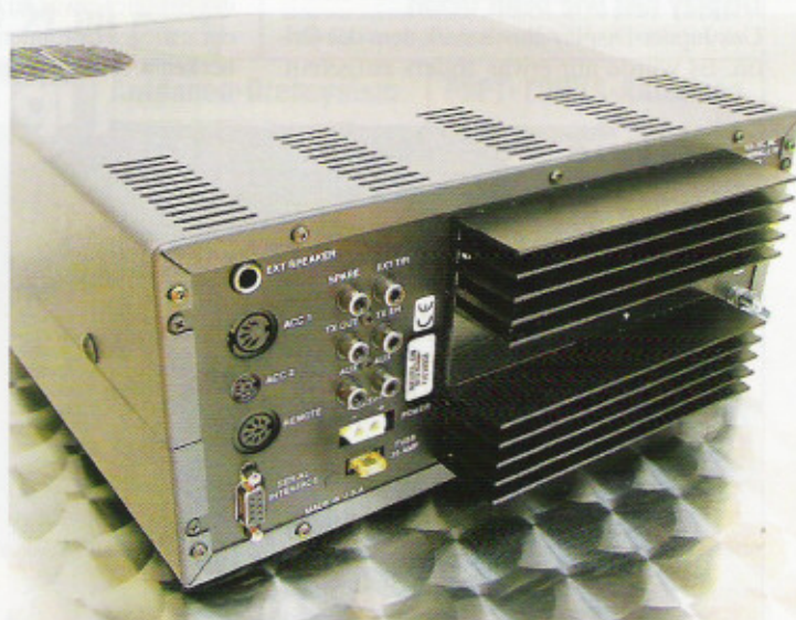
Die Ten-Tec-typische Rückseite wird vom Kühlkörper dominiert, an dem leicht ein Lüfter angebracht werden kann.
