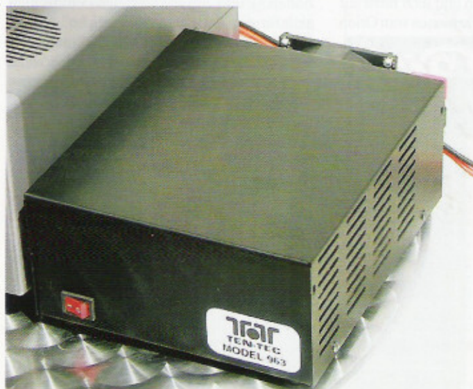
Das Schaltnetzteil sollte frei stehen, da es erhebliche Abwärme entwickelt. Der rückseitig montierte Lüfter sorgt für genügend Luftdurchsatz.
