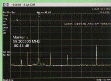
Senderausgangsspektrum auf 10 m.
