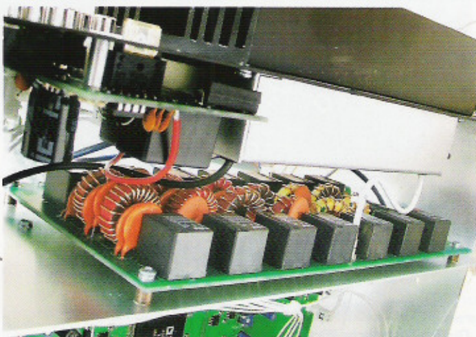
Der Automatiktuner ist senkrecht eingebaut.
