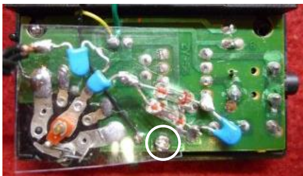
(6) 基板を下ケースにねじで固定
