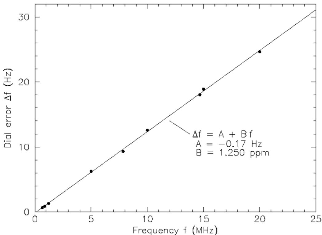
Execute frequency calibration cycleで良い結果がでたら、ftm.allファイルをチェックしましょう。直線回帰手順はSolve for calibration parametersをクリックすることで自動的に実行できます。結果は次のように表示されます。SlopeとInterceptには不確実性も表示されます。Nは直線回帰に使われた周波数数を表します。StdDevはその標準偏差値です。結果が妥当と思われる場合はApplyボタンを押します。すると結果がSettings→Frequencies→Frequency Calibrationに記憶されます。
