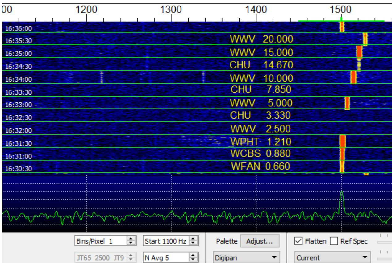
周波数シンセサイザーを使った最近の無線機であれば、1500Hzから少し離れた周波数は線形に変化します。測定した周波数オフセット(Hz)を信号の周波数で割り算すると較正できます。たとえば、上のスクリーンショットで、20MHzのWWV信号が24.6Hzのトーンオフセットを有しているとWSJT-Xのデコードウィンドウに表示されています。較正定数は $24.6/20=1.23$ と計算できますので、この値をSettings | FrequenciesタブのSlopeへ入力します。
