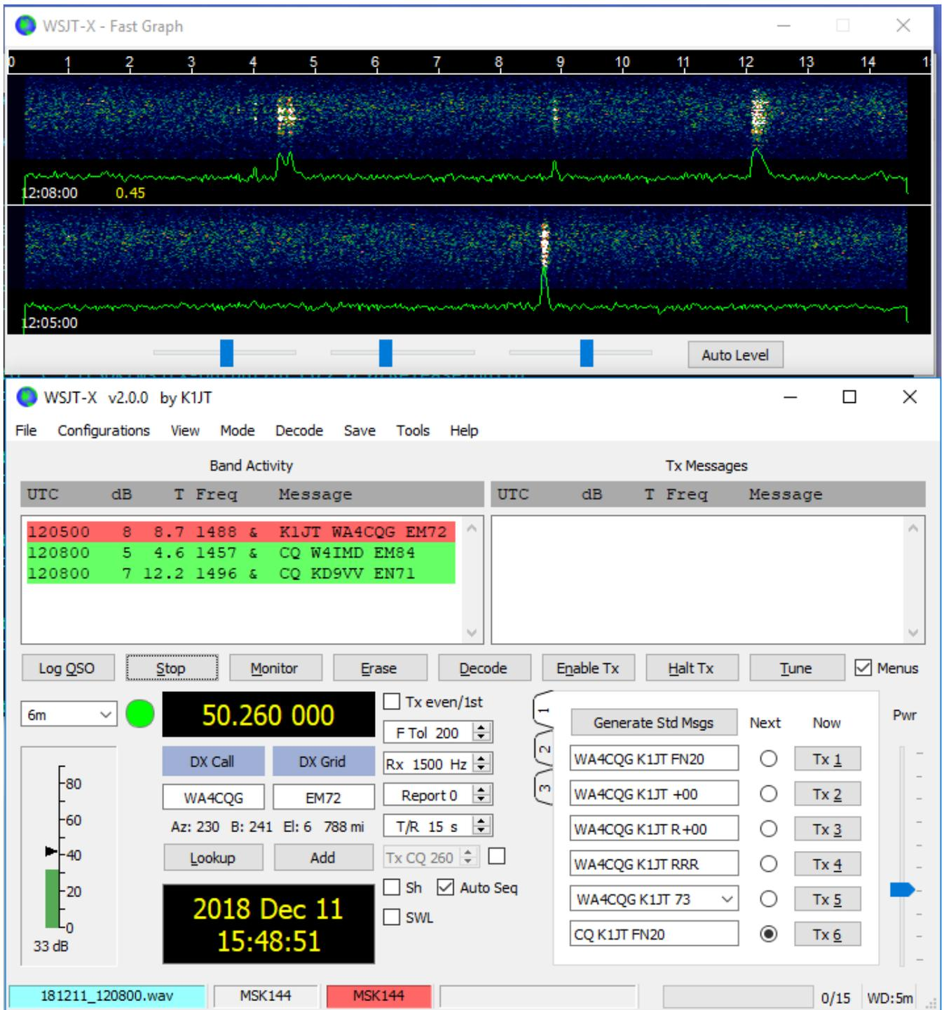
他のWSJT-Xモードとは異なり、MSK144デコーダはリアルタイムで動作します。デコードされたメッセージは、信号を受信してから、ほぼ瞬時に表示されます。
