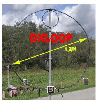
Realizzo il loopino usando la tecnica dell' infinite loop consigliatami da Giancarlo I7SWX, Giancarlo mi consiglia di mettere il loopino in basso ed il condensatore in alto, ma io per motivi di praticità ad arrivare con la mano sul condensatore non l'ho potuto fare... così questo è il risultato:
