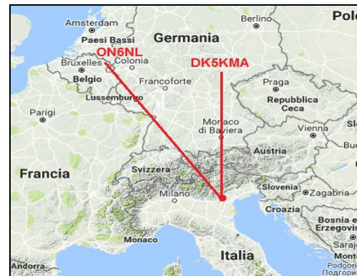
Fig.2 La mappa dei QSO con ON6NL (skip 745 km) e con DK5KMA (skip 531 km) effettuati con 100 watt e una semplice Yagi 2 elementi.
