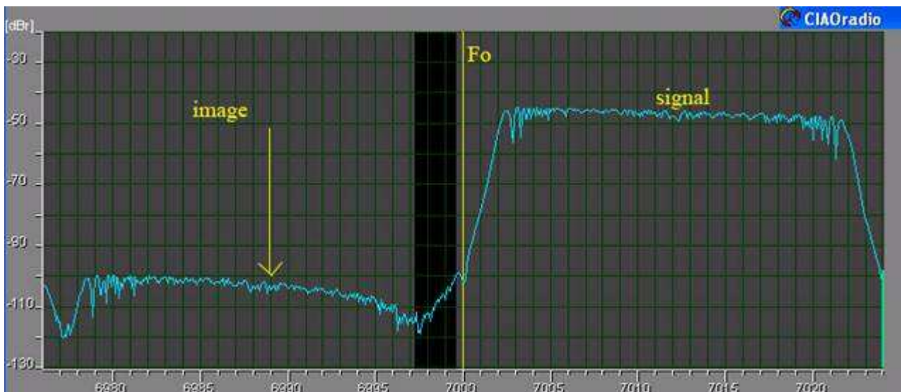
Fig.4 – Ricezione con CIAOradio di un segnale di test (1) con spettro di 20 KHz
