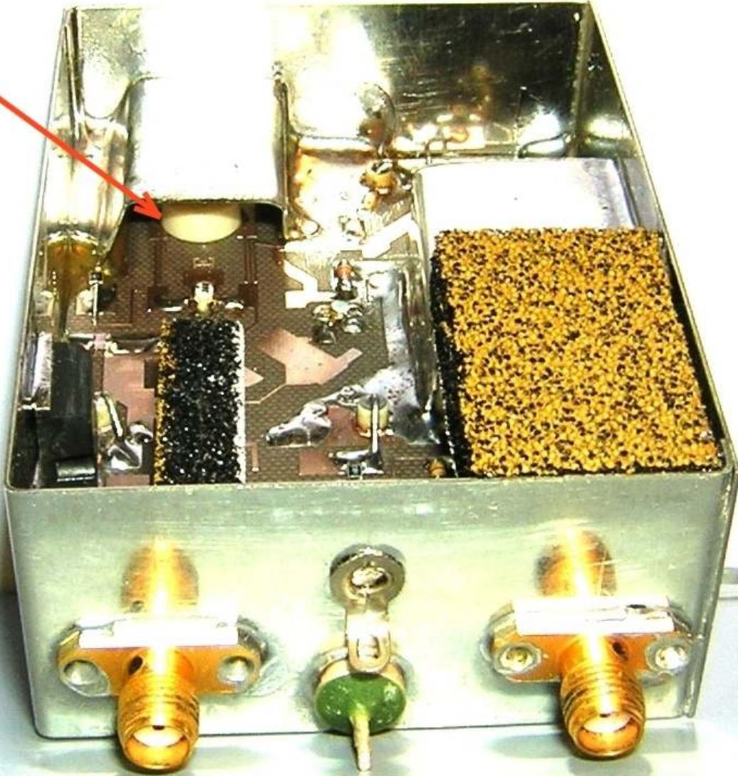
**Fig.10C - Il risonatore a dielettrico (indicato con la freccia rossa) e' posizionato simmetrico tra le due microstrip dello stadio oscillatore ed e' vincolato al circuito stampato con resina epossidica.**
