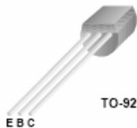
**Con el Transistor con parte plana:**
