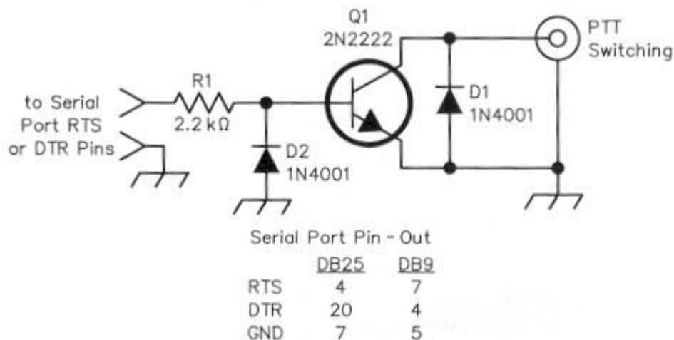
Todo este circuito junto al conector hembra del DB9 se introduce dentro del housing del DB9 y se conecta al puerto serial de la PC.
