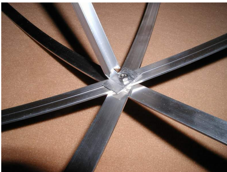
Figure 6 : Détail sur la fixation d'un bras support de source
