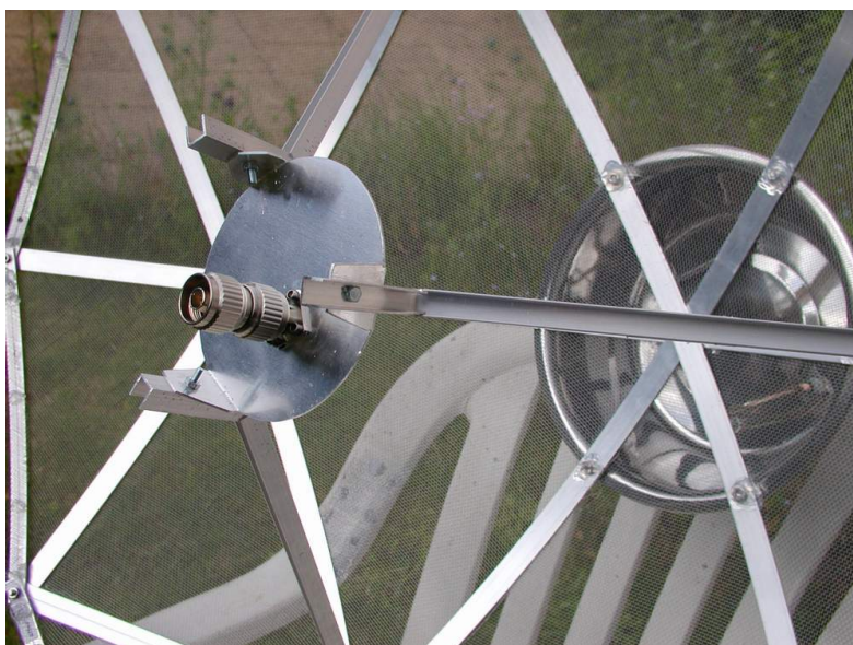
Figure 8 : Exemple de réalisation avec une antenne patch (le convertisseur est monté sur la prise N).
