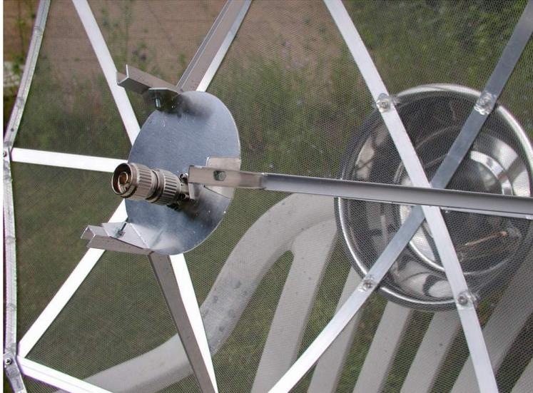
**Exemple de réalisation avec une antenne patch (le convertisseur est monté ensuite sur la prise N).**
