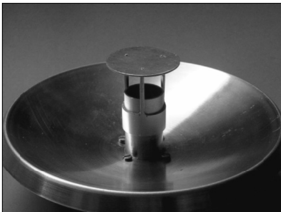
Prototype d'antenne 10GHz (diamètre 15cm)
