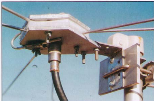
Le "sandwich", l'équerre de fixation et la bride provenant d'une antenne TV.
