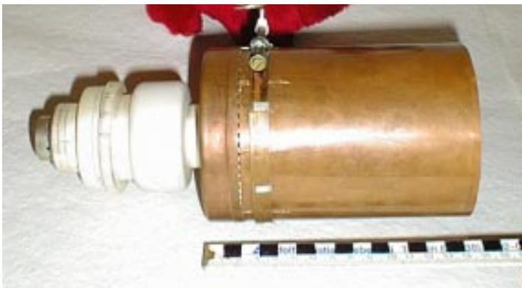
**Picture 29: GS35b mit aufgesetztem Resonator
