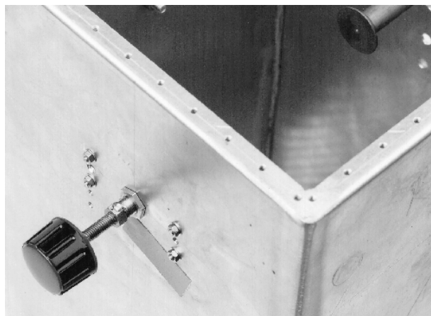
Picture 20: Outer side of tune, Load Rotor in the background Außenansicht des Tune-Kondensators, im Hintergrund Load-Rotor
