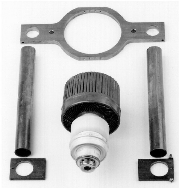
Picture 11: Parts of the resonator (without Part R 2 und Part R 3) Einzelteile des Resonators (ohne Part R 2 und Part R 3)
