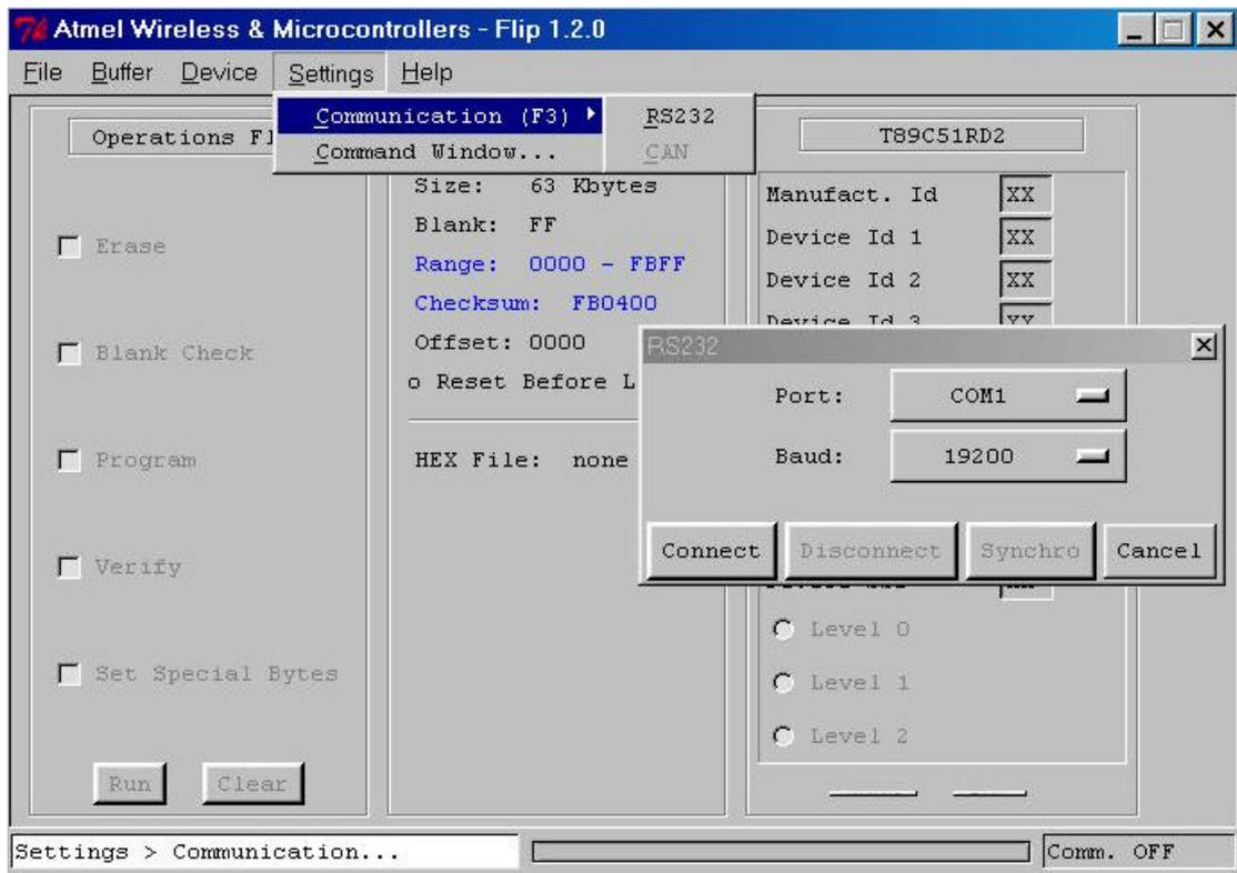
Wenn alles stimmt, baut sich nun automatisch die Verbindung zum CRO Board auf. Funktioniert die Kommunikation aus irgend einem Grunde nicht, wird nach einiger Zeit eine Fehlermeldung ausgegeben. Es empfiehlt sich dann die V24-Leitung, die Kurzschlussbrücke bei SV2 zu überprüfen, sowie das CRO-Board erneut aus- und einzuschalten und die Einstellungen beim ISP-Tool nochmals zu tätigen.
