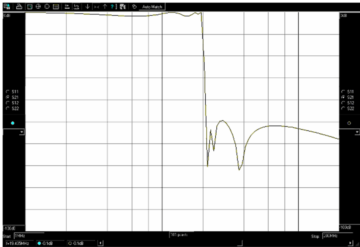
Abb. 6.1-5 Amplitudengang des Rekonstruktionstiefpasses (10 dB/div)
