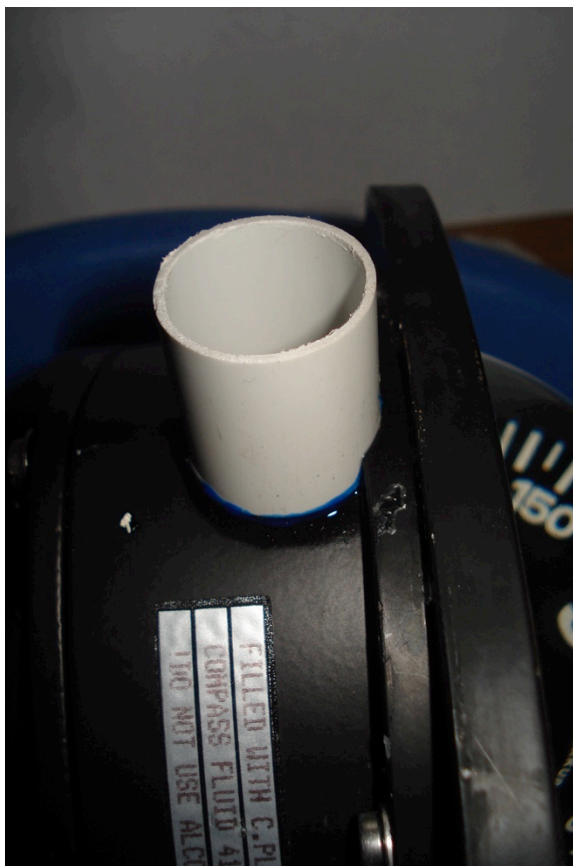
Bild 7: Einfülldom aus Elektroinstallationsrohr
