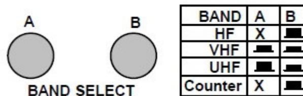
**X** bedeutet, dass der VHF / UHF-Taster in irgendeiner Position stehen kann. Die Abstimmung im VHF- und UHF-Bereich ist durchgehend. Das Display zeigt sowohl die Sendefrequenz in MHz als auch den Buchstaben vom ausgewählten Bereich.
