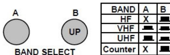
Ist ein HF- Signal am Eingang vorhanden, wird die Frequenz in MHz angezeigt. Zwei Tor-Zeiten sind einstellbar. Die Standard- Tor- Zeit des Gatters ist **Fast** (oder **Fg** - siehe oben rechts im Display. Diese schnelle Tor- Zeit hat 1 kHz Auflösung. Die alternative Tor- Zeit ist **Slow** (oder **Sg**), diese hat 100 Hz Auflösung. Um die Tor Zeit zu ändern:
